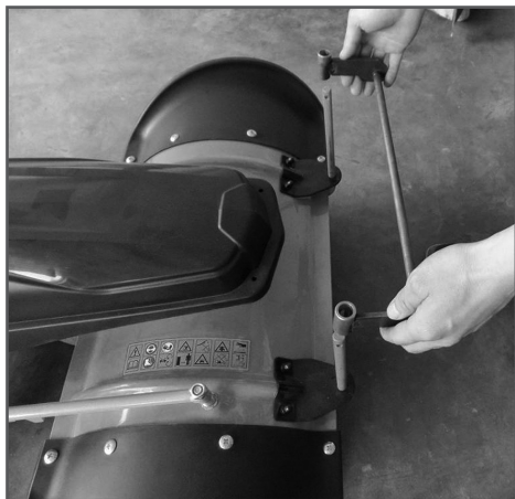
Рис 3. Установка промежуточной скобы
