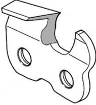
Рис. 16 Режущая кромка зуба
