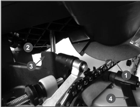
Рис. 17 Регулировка глубины заточки
