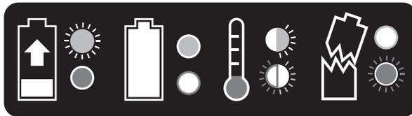
Рис. 3 Состояние индикации зарядного устройства
