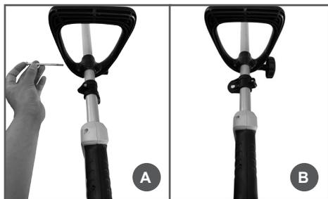
**Рис. 6 Установка рабочей рукоятки**
