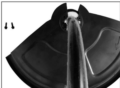
Рис. 3 Установка защитного кожуха
