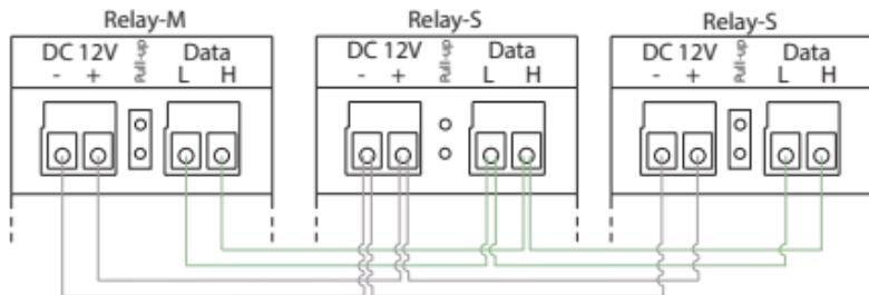
Для подачи питания на ведомое устройство соедините кабелем\*, соблюдая полярность, клеммы DC 12V блока Relay-4M и ведомого устройства.
