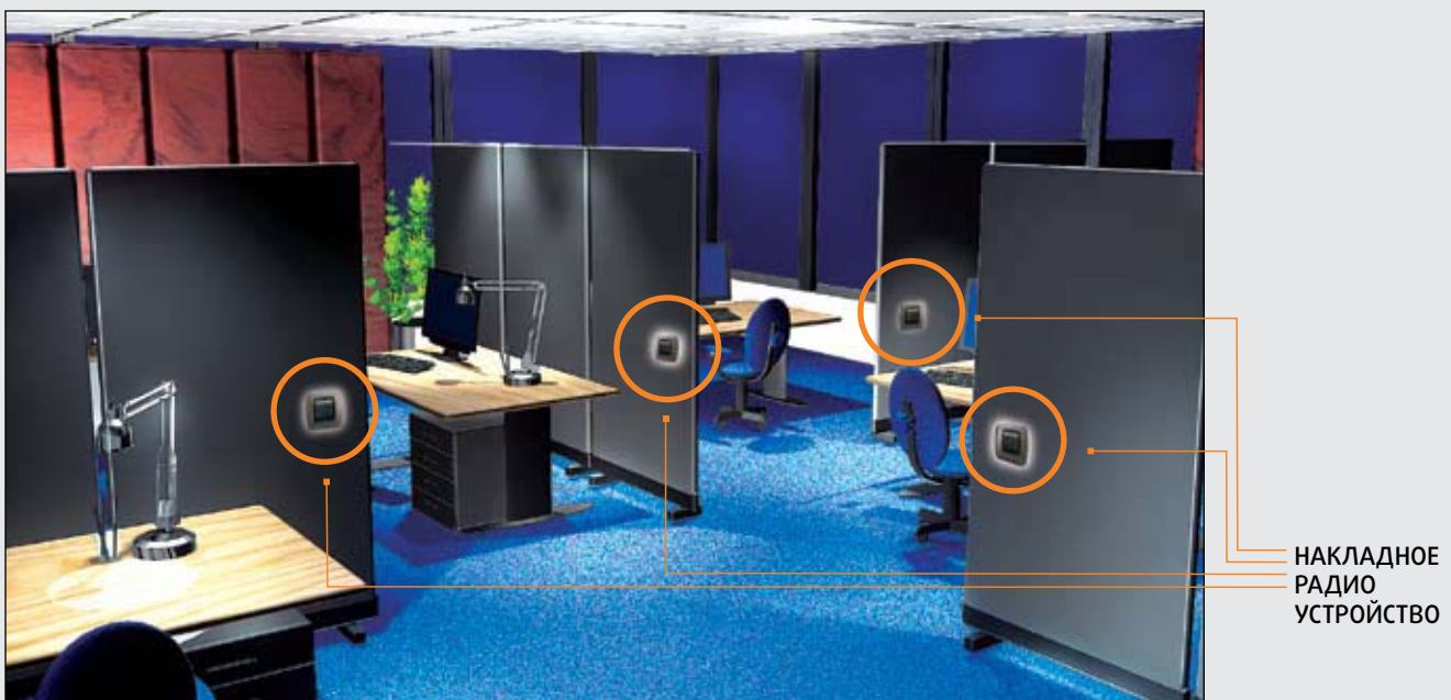
Пример использования радио управления в помещении с мобильными перегородками.
