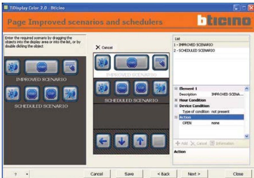
Программа TiDisplay Color Пример определения графических символов для функции Сценарий
