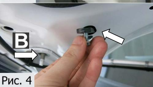
4. Открутить верхнюю гайку крепления капота В торцевой головкой №13. Вкрутить на 4-6 оборотов болт M6x20 с шайбой 6 в гайку закладную. Завести в штатное отверстие капота гайку закладную
