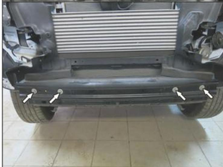
13. Выкрутить 4 болта крепления переднего усилителя к раме автомобиля. Демонтировать усилитель.
