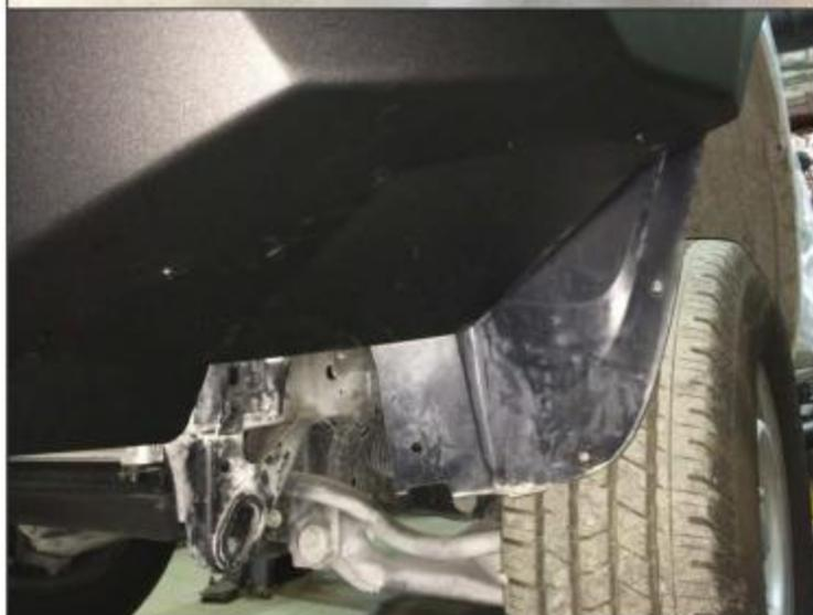
34. Установить фартуки на автомобиль, используя винты М6х20(поз.18) и шайбы(поз.24). Фартук должен зайти внахлест внутрь облицовки бампера.
