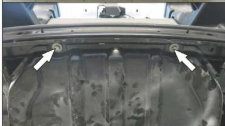
12. Выкрутить 2 болта крепления защиты двигателя к переднему усилителю.
