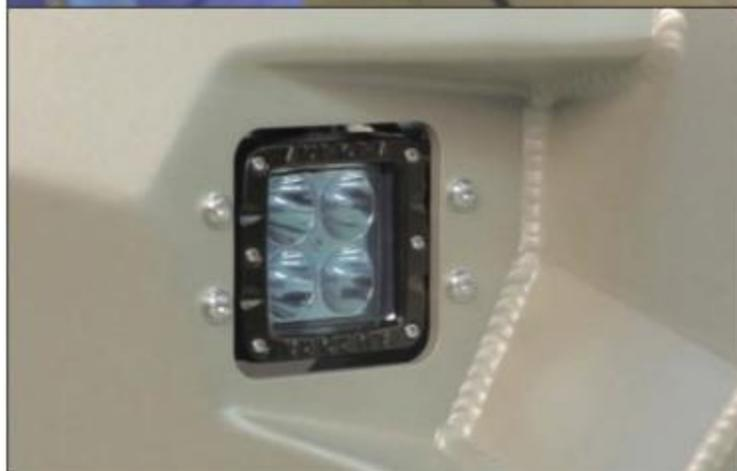
26. \*Установить фонари вместе с кронштейнами в облицовку бампера, используя винты М6х16 (поз.17) и шайбы (поз.23). Окончательно отрегулировать положение фонаря.
