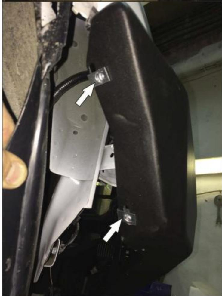
31. Установить гайки М6 квадратные(поз.21) на облицовку.
