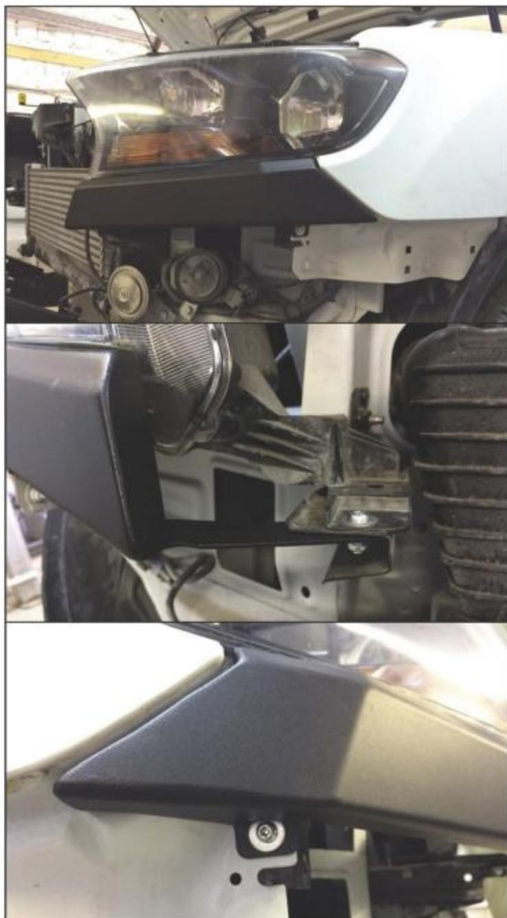
17. Установить накладки(поз.10 и поз.11) на автомобиль. Крепить винтами М6х20(поз.18), гайками М6(поз.20) и шайбами(поз.24).
