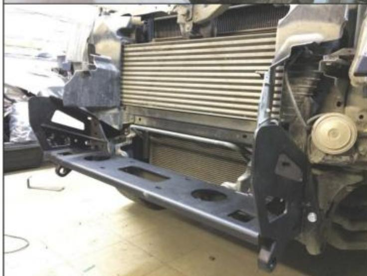
19. Установить площадку лебедки(поз.2) на раму автомобиля. Крепить болтами M10x25(поз.14), гайками M10(поз.22) и шайбами(поз.25). Резьбовые соединения не затягивать.
