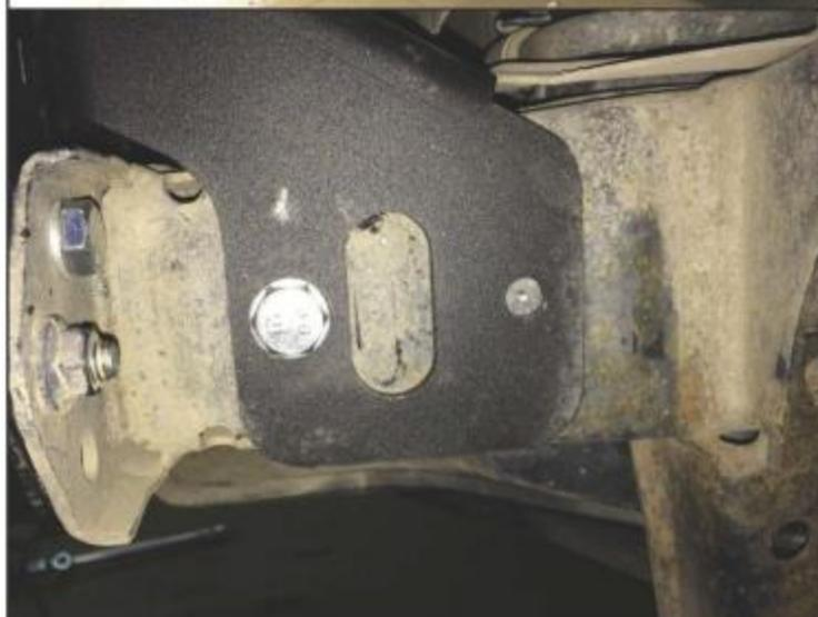
20. Установить усилители(поз.6 и поз.7). В верхней части закрепить к площадке лебедки болтами M10x25(поз.14), гайками M10(поз.22) и шайбами(поз.25). Через штатное отверстие в раме временно закрепить усилитель к закладной M12(поз.12) болтом M12x30(поз.16) и шайбой(поз.27). Наметить отверстие для сверления. Снять усилитель, просверлить отверстие диаметром 12мм. Установить усилитель.
