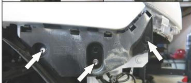
15. Выкрутить по 3 винта крепления пластиковых фиксаторов бампера на крыльях слева и справа.
