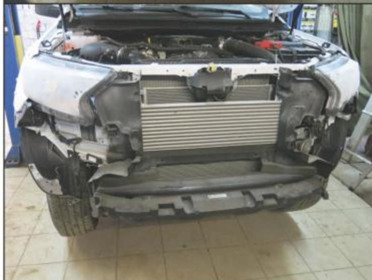
10. Демонтировать бампер. Потянуть край бампера на себя, отстегнув защелки, двигаясь от края к центру бампера.
