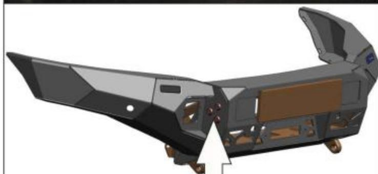
29. Вставить винты M10x30(поз.19) с потайными шайбами(поз.29) слева и справа. Накрутить гайки M10(поз.22) с шайбами(поз.26). Резьбовые соединения не затягивать.
