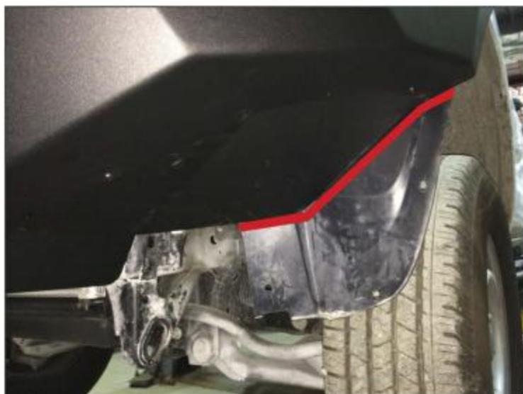
35. Прижать фартуки к пластиковым подкрылкам автомобиля, отметить маркером линию реза и обрезать пластиковый подкрылок.
