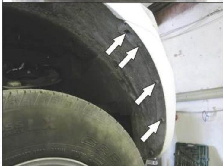
3. В арках автомобиля открутить по 1 болту и извлечь по 3 пистона с каждой стороны.
