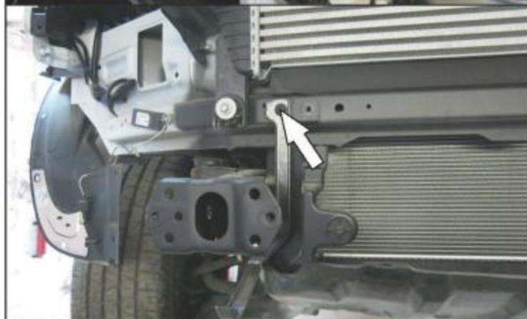
16. Выкрутить винты крепления пластин бампера. демонтировать пластины.
