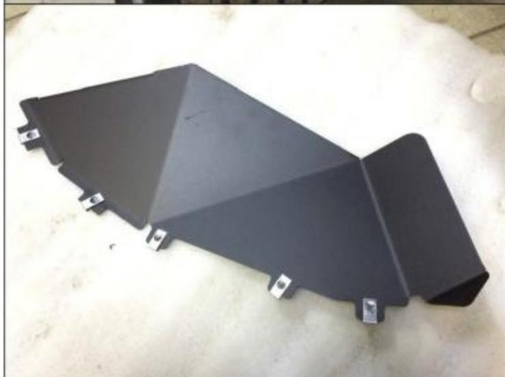
33. Установить гайки М6 квадратные(поз.21) на фартуки(поз.8 и поз.9).
