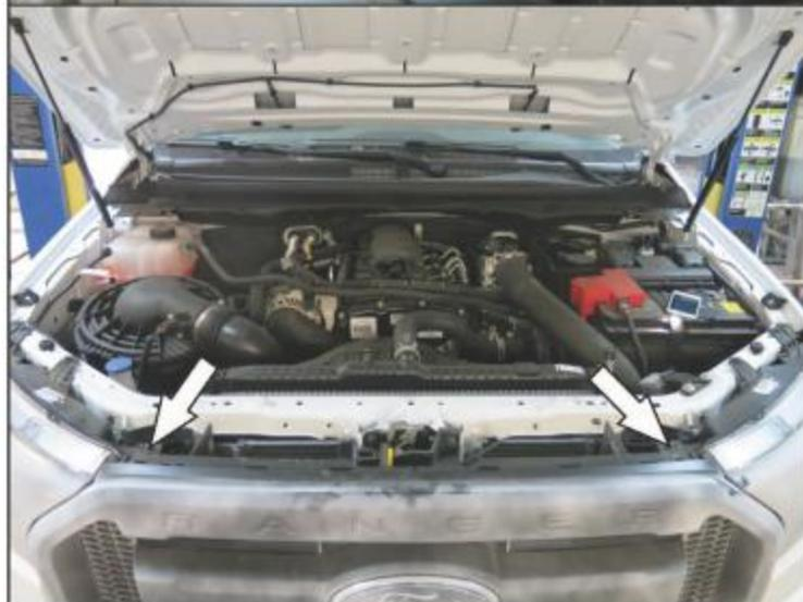
7. Выкрутить два болта крепления решетки радиатора в верхней части.
