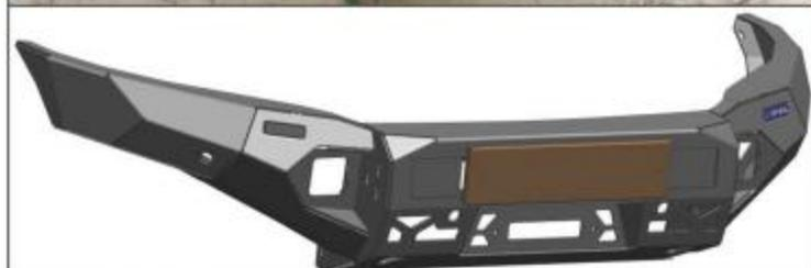
23. Установить площадку номера на облицовку бампера, используя болты М6х16 (поз.13). Протянуть резьбовые соединения.
