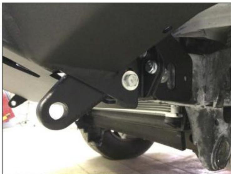
28. Установить облицовку (поз.1) на площадку лебедки (поз.2). В нижней части закрепить облицовку к кронштейнам болтами M10x30(поз.15), закладными M10 (поз.5) и шайбами(поз.26). Резьбовые соединения не затягивать.
