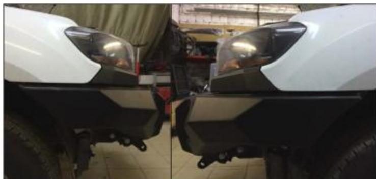
30. Выровнять облицовку бампера по линиям автомобиля. Обеспечить равномерные зазоры слева и справа. Затянуть все резьбовые соединения.
