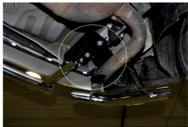
Рис. 5 - Совместная установка защиты R.3305.007 и уголков R.3305.005
