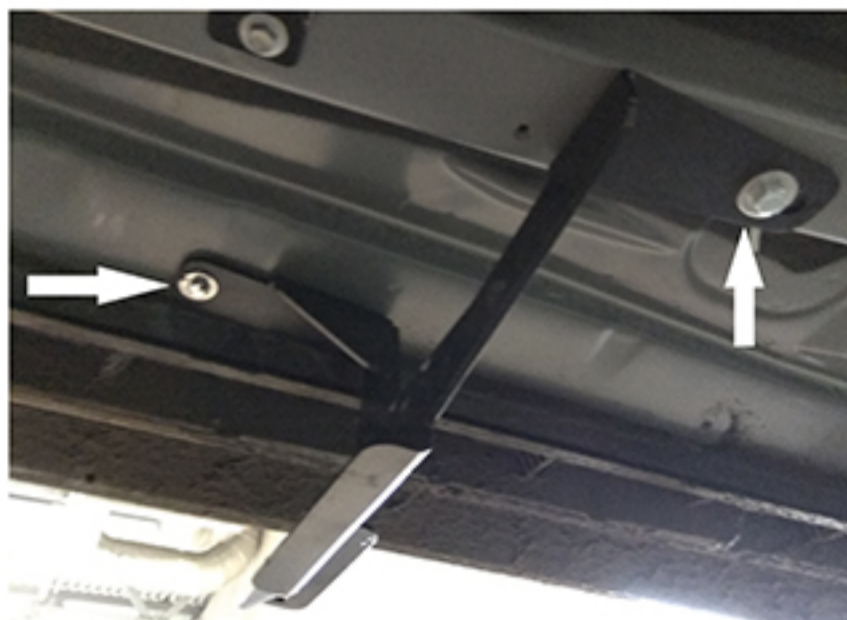
Рис. 5 - Установка среднего кронштейна
