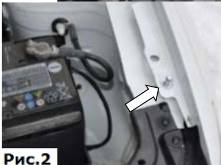
2. Установить болт-шарнир с шайбой на крыло как показано на рисунке. Затянуть болт ключом №10 с усилием 9 Нм, (Рис.2).
