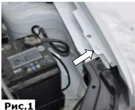
1. Открутить болт крепления крыла, (Рис.1).
