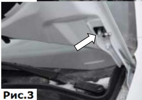
3. Открутить верхнюю гайку крепления капота. Установить кронштейн капота, уперев его в ребро жесткости. Затянуть гайку ключом №13 с усилием 23 Нм, (Рис.3).
