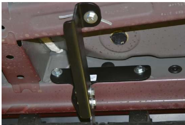
Рис. 4 - Установка опоры и кронштейна в передней части автомобиля
