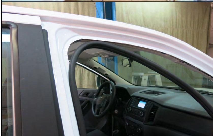
4. Демонтировать уплотнитель с дверных проемов.
