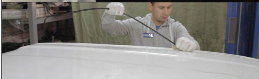
24. Убрать из желоба крыши пластиковую накладку. Удалить с крыши липкую ленту.
