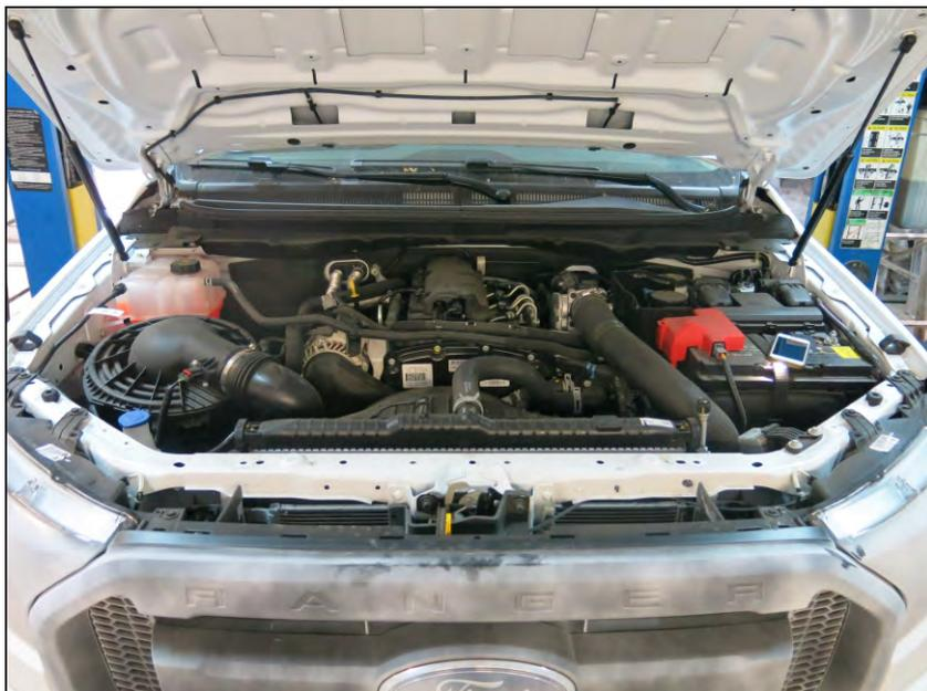
1. Открыть капот, отсоединить «минусовую» клемму от аккумулятора.
