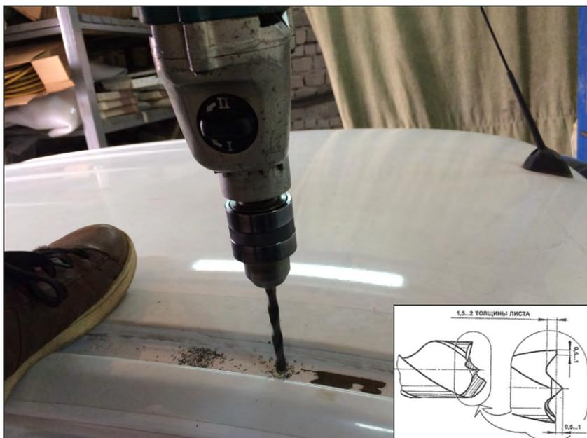
27. Просверлить отверстия в крыше диаметром 8-8,5мм. Во время сверления со стороны салона рекомендуется подложить металлическую пластину, для избежания повреждения подушки безопасности.
