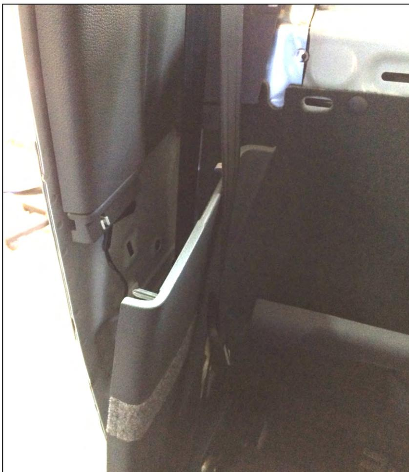
8. Отщелкнуть верхнюю часть накладки с задних стоек возле ремня безопасности.
