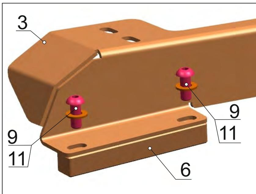
29. Установить на опоры(поз.6) кронштейны(поз.3 и поз.4), используя винты М8х20(поз.9) и шайба(поз.11).
