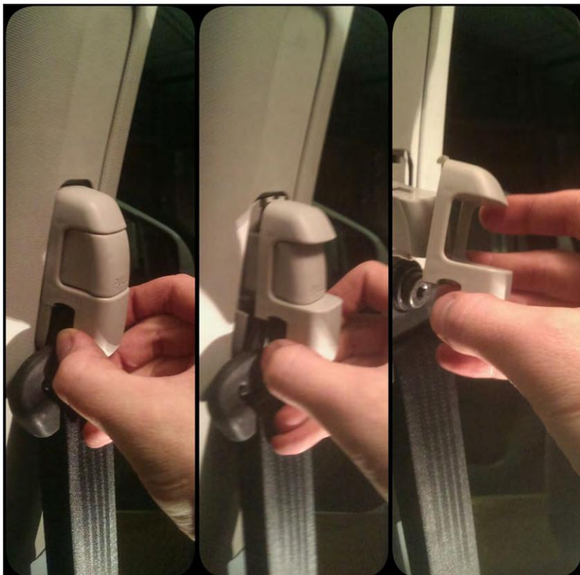
12. Демонтировать заглушки болтов крепления ремня безопасности на центральных стойках.
