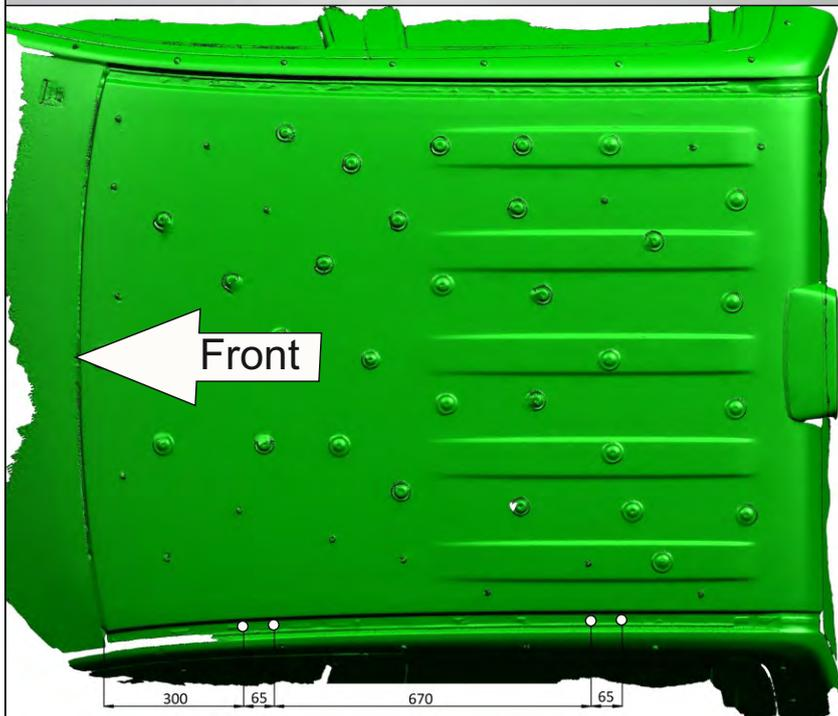
25. Разметить отверстия для сверления в крыше автомобиля. Размеры размечать от края лобового стекла.
