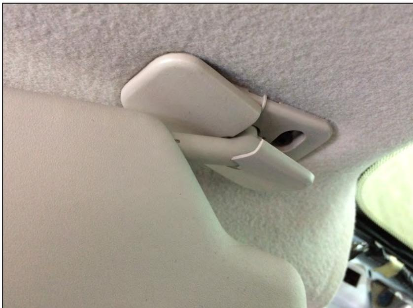
17. Снять пластиковую заглушку с крепления солнцезащитного козырька.
