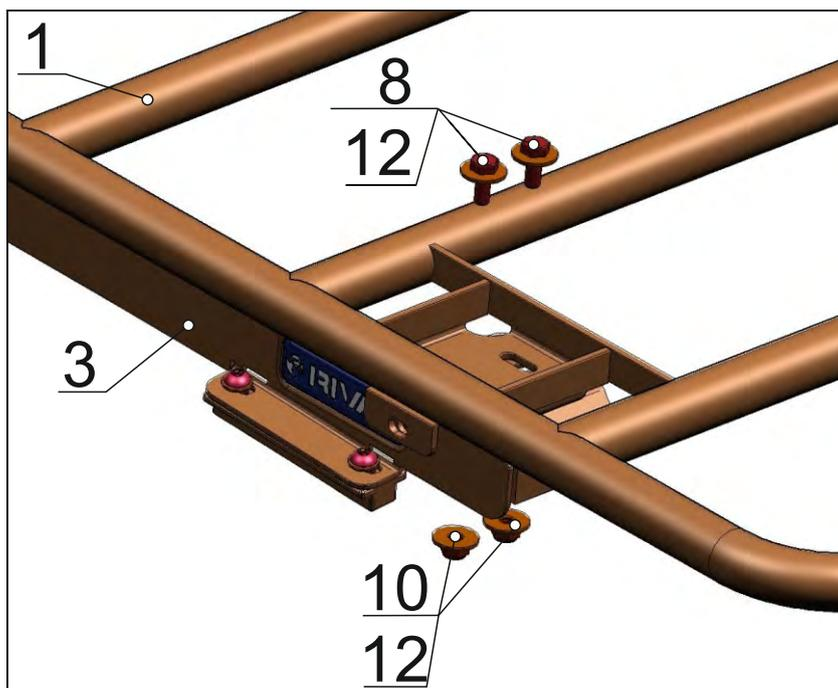
30. Установить нижний ярус(поз.1) на кронштейны(поз.3 и поз.4). Закрепить болтами М8х20(поз.8), гайками М8(поз.10) и шайбами(поз.12).
