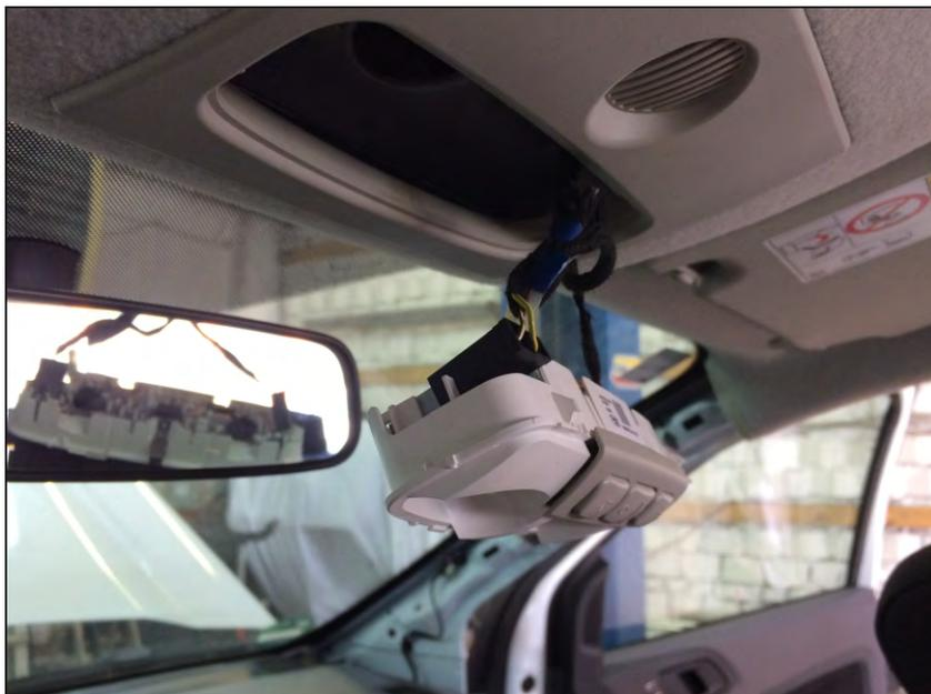
20. Снять плафон подсветки салона, отсоединить провода.
