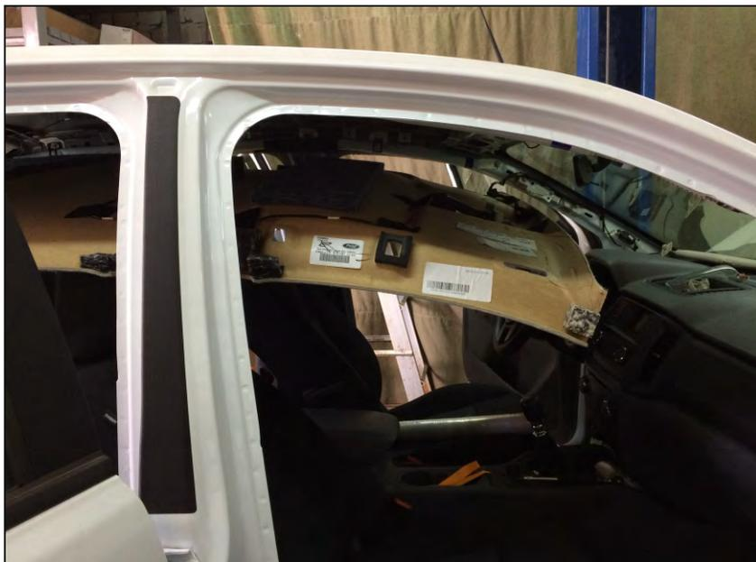
23. Снять обшивку с потолка автомобиля.
