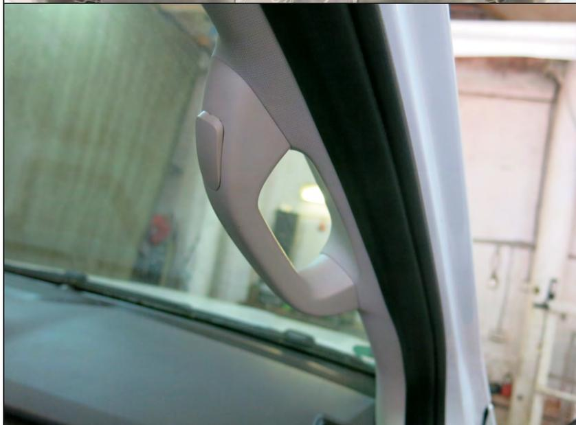
2. Снять ручки на передних стойках.
