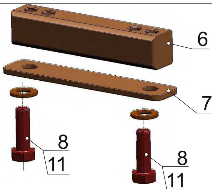
28. Установить опоры(поз.6) на крышу автомобиля. Закрепить, через заранее просверленные отверстия, болтами М8х20(поз.8) и шайбами(поз.11) и внутренними пластинами(поз.7). В места соприкосновения двух деталей, а также на резьбовые соединения нанести кузовной полиуретановый герметик. Установить пластиковые наклейки в желоб крыши, предварительно подрезав их в месте установки опор.
