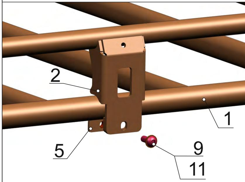
31. Установить верхний ярус(поз.2) на нижний ярус(поз.1), используя закладную(поз.5), винты М8х20(поз.9) и шайбы(поз.11). Протянуть все резьбовые соединения.
