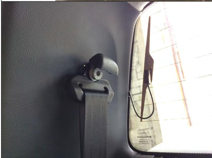
9. Открыть заглушку болта крепления ремня безопасности на задних стойках, выкрутить болт крепления ремня безопасности.
