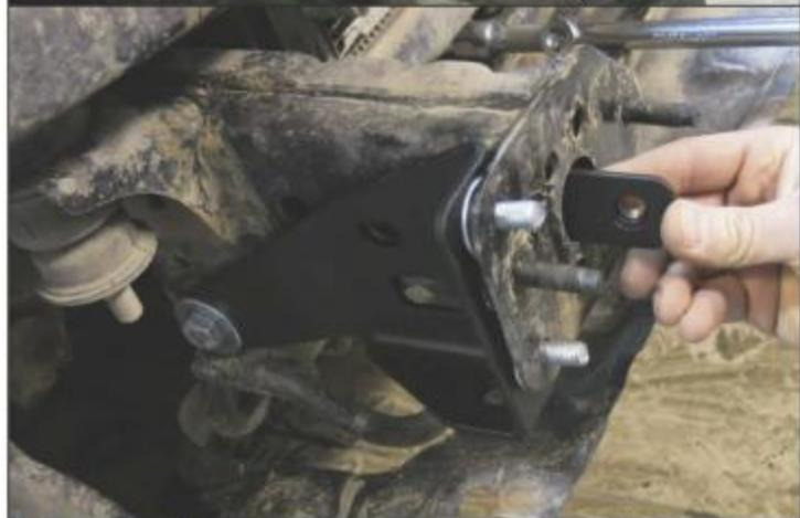
18. Внутри рамы завести закладную 2xM12 (9). Закрутить болты M12x30 (19) с шайбами M12x37 (31).
