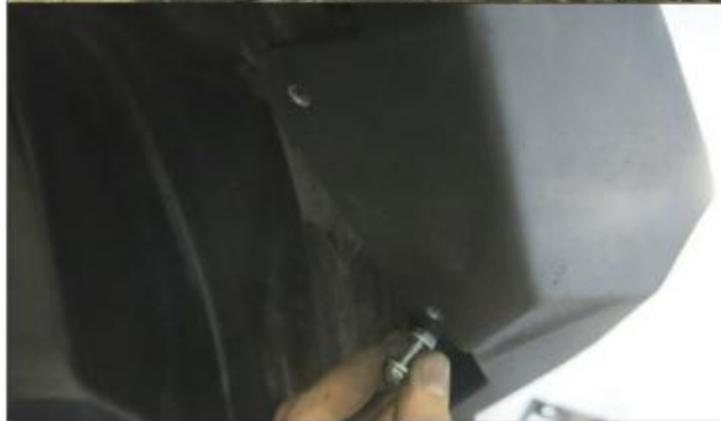
35. Установить на фартуки (7, 8) гайки квадратные М6 (25) как показано на фото. На левом фартуке в выделенном месте гайка не устанавливается.
