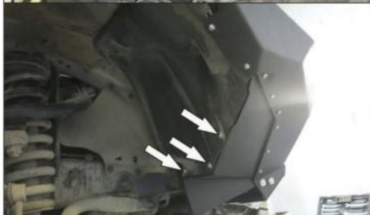
40. Наметить отверстия в пластиковых подкрылках напротив отверстий в фартуках. Просверлить, используя сверло диаметром 6-7мм. Внимание! Будьте аккуратны, чтобы не повредить гайки.
