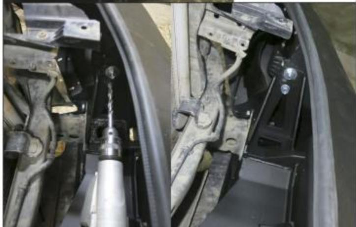
31. Через имеющиеся отверстия в площадке лебедки по месту просверлить отверстия диаметром 10мм в облицовке бампера.
