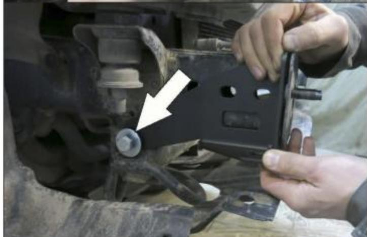
16. Установить усилитель рамы (3). Для этого в штатное отверстие в раме вкрутить болт М12х30х1,25 (18) с шайбой М12х37 (31).
