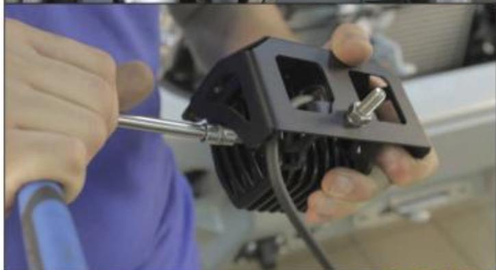
32. \* Установить фонари в кронштейны (6). Выровнять фонарь относительно кронштейна. Протянуть соединения.
