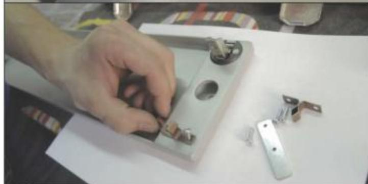
24. Установить ответную часть роликовой защелки на площадку номера (5) при помощи винтов М3х12 (20) и закладной (10).
