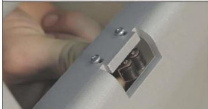
23. Установить роликовые защелки (32) в облицовку бампера (1), используя винты М3х12 (20) и гайки М3 (24).
