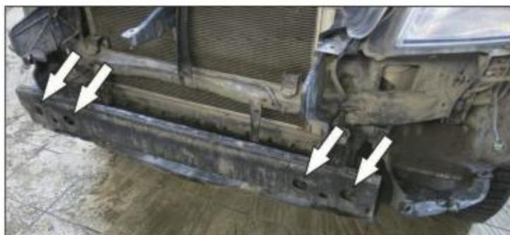
8. Открутить гайки и демонтировать брус безопасности.
