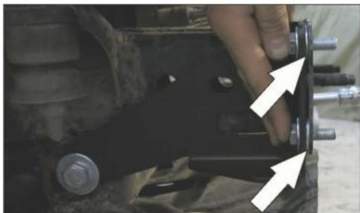
17. Вставить болты M10x30 (17) с шайбами M10x30 (30). Прижать усилитель рамы к переднему фланцу рамы. Если между ними остался зазор более 2мм - вставить шайбы M10x30.
