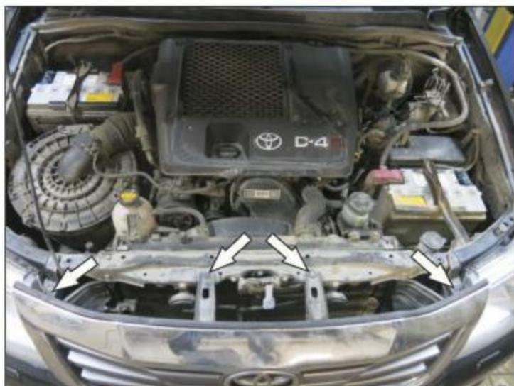
1. Выкрутить винты и удалить пластиковые пистоны фиксирующие радиаторную решетку сверху.
