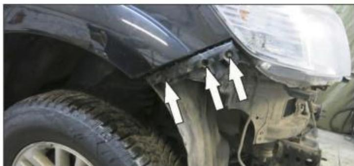
13. Извлечь пистоны и открутить болты М6. Демонтировать пластиковые фиксаторы бампера на крыльях слева и справа.
