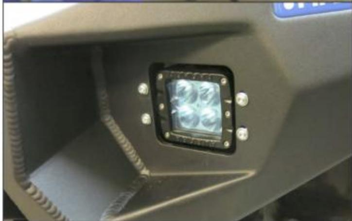
33. \* Установить фонари вместе с кронштейнами в облицовку бампера, используя винты M6x16 (21) и шайбы M6x12 (27). Окончательно отрегулировать положение фонаря.
