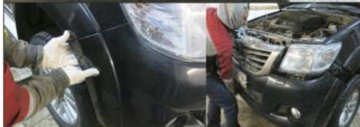
7. Демонтировать бампер. Для этого, потянув край бампера на себя, отстегнуть защелки. Постепенно двигайтесь от арки колеса к центру бампера. Отсоединить разъемы фонарей. Отсоединить шланг омывателя фар от насоса.
