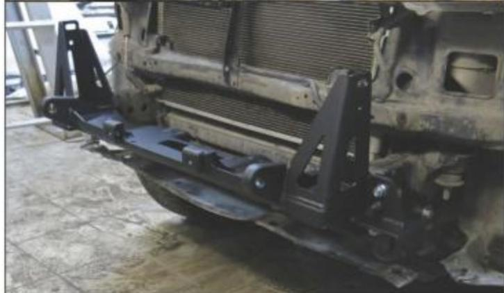
19. Установить площадку лебедки (2) на автомобиль. Неплотно прикрутить используя: штатные гайки, болты M10x30, болты M10x25, шайбы M10x20, шайбы M10x30 и гайки M10 из комплекта крепежа как показано фото.
