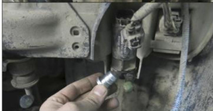
15. Отсоединить разъем от насоса омывателя фар. Демонтировать насос и установить вместо него заглушку (13) из комплекта крепежа.
