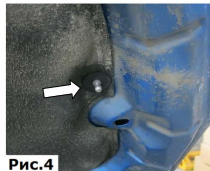
4. Затянуть болт-шарнир торцевой головкой №12 с усилием 9 Нм, (Рис.4.)
