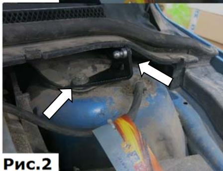
2. Установить кронштейн, затянуть болты ключом №13 с усилием 23 Нм, (Рис.2).
