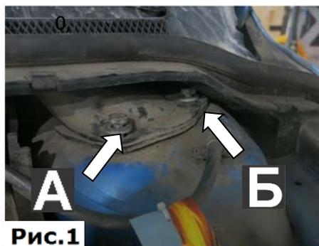
1. Открутить болт крепления чашки **А** и ослабить **Б**, (Рис.1).
