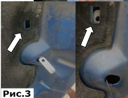
3. Установить болт-шарнир с шайбой 8 и закладной в указанное отверстие, (Рис.3).
