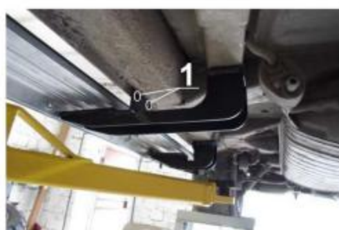
Рис.7 Разметка крепёжных отверстий
