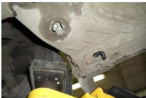
Рис.2 Место крепления переднего кронштейна
