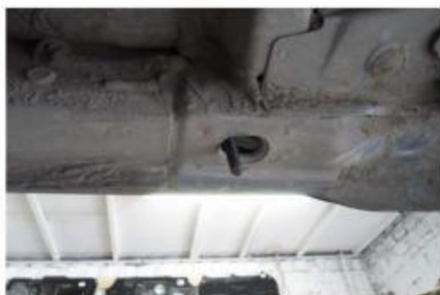
Рис.8 Место крепления заднего кронштейна
