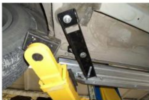
Рис.4 Крепление переднего кронштейна
