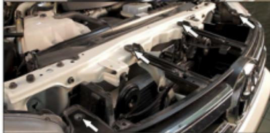
2. Выкрутить винты фиксирующие радиаторную решетку. Демонтировать радиаторную решетку отогнув пластиковые фиксаторы в месте стыка с бампером.
