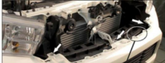
3. Выкрутить винты фиксирующие бампер в верхней части и извлечь пистоны
