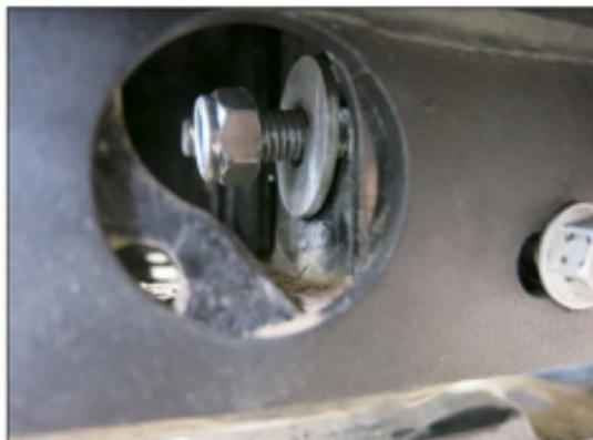
14. Закрепить кронштейн лебедки болтами M12x30(поз.7), гайками M12(поз.11), шайбами(поз.15 и поз.17). Затянуть все резьбовые соединения.
