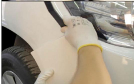
6. Демонтировать бампер. Для этого, потянув край бампера на себя, отстегнуть защелки. Постепенно двигайтесь от арки колеса к центру автомобиля.
