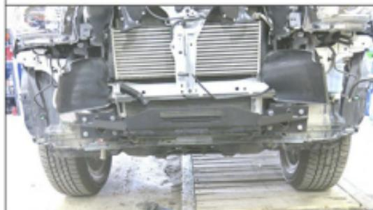
12. Установить кронштейн лебедки(поз.1) на раму автомобиля в место крепления бруса безопасности. Крепить штатными болтами, болтами М10х30(поз.6), гайками М10(поз.10) и шайбами(поз.14). Резьбовые соединения не затягивать.
