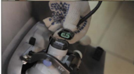
7. Отсоединить шланг омывателя фар от насоса. Отсоединить разъемы фонарей. Перед снятием шланга рекомендуется слить омывающую жидкость.
