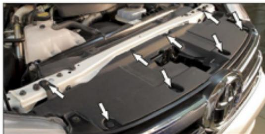
1. Открыть капот и демонтировать пластиковую накладку. Для этого извлечь пистоны. Сохраняйте крепеж для последующей установки.
