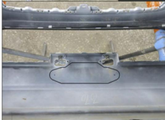
15. Временно установить штатный бампер для разметки отверстия под клюз.
