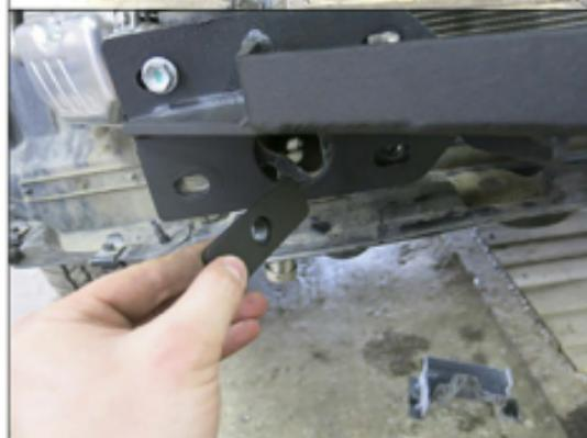
13. Закрепить кронштейн лебедки к закладной М12(поз.4). Закладную завести в отверстие в раме. Крепить болтом М12х30(поз.7), шайбами(поз.15 и поз.16). Резьбовые соединения не затягивать.
