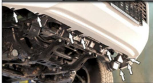
4. Выкрутить винты фиксирующие бампер в нижней части.
