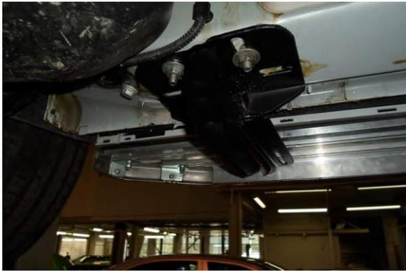
Рис.4 Установка переднего кронштейна
