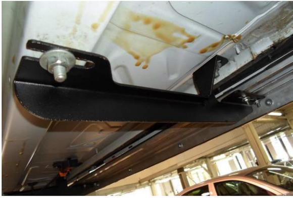
Рис.2 Установка переднего кронштейна
