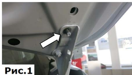
1. Открутить верхнюю гайку крепления капота торцевой головкой №12, (Рис.1).
