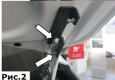
2. Установить кронштейн капота. Кронштейн фиксируется гайкой М8 спец. с шайбой 10. Также закрепить кронштейн к петле капота болтом М6х16 с двумя шайбами 6 ув. и гайкой М6. Прижать кронштейн к боковой стенке петли и сдвинуть до упора вниз (к лобовому стеклу). Затянуть болт М6х16 торцевой головкой №10 с усилием 9 Нм. Затянуть гайку М8 спец. торцевой головкой №13 с усилием 23 Нм, (Рис.2).
