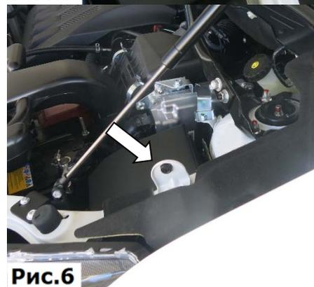
8. Демонтировать штатный упор, (Рис.6). Плавно и без рывков не до конца закрыть капот. Убедиться в отсутствии контакта кронштейнов и амортизаторов с агрегатами и элементами кузова автомобиля.
