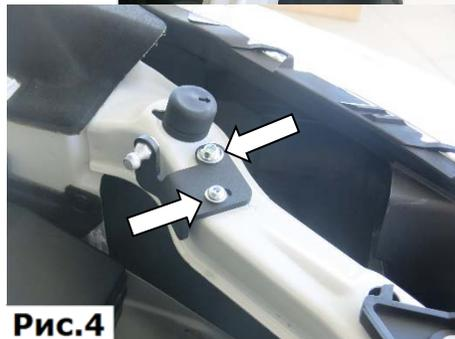
4. Установить кронштейн крыла. Вкрутить винт М6х20 с шайбой 6 в штатное резьбовое отверстие, закрепить винтом М8х20 с шайбой 8 и гайкой М8 в штатном отверстии. Прижать кронштейн к боковой стенке усилителя (в сторону фары). Затянуть винт М6х20 вставкой-битой HEX №4 с усилием 9 Нм. Затянуть винт М8х20 вставкой-битой HEX №5 с усилием 23 Нм, (Рис.4).
