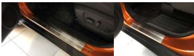
Фото установленных накладок
