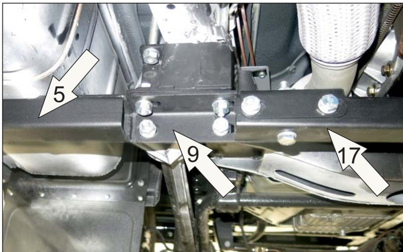
3. Установить передние крепежи (поз.5, 6) и соединитель (поз. 17), через переходники (поз. 9, 10) используя болты М10х65, М10х30, гайки М10, шайбы 10).
