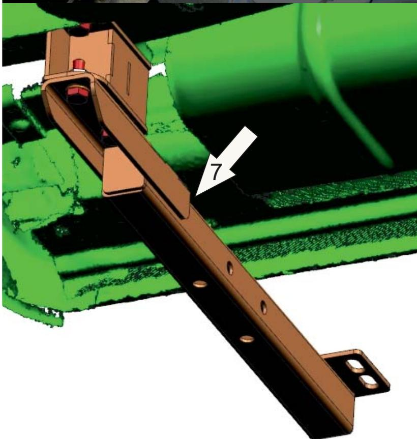
2. Установить задние крепежи (поз.7,8) на проставки, с помощью болтов M10x30 и шайб 10.
