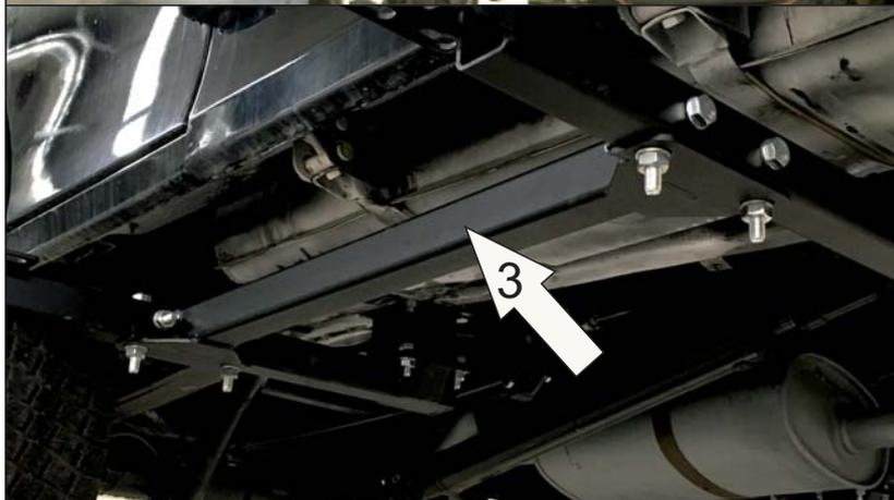
4. Установить усиления (поз. 3 и 4) с помощью болтов М10х65, гайкой М10, шайбой 10.
