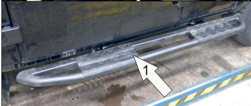
5. Установить порог на крепежи с помощью болтов М10х30 и шайб 10.
