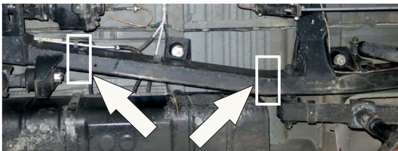
1. Установить зацепы и проставки на раму автомобиля в передней и задней части автомобиля с помощью болтов M10x150, и шайб 10.
