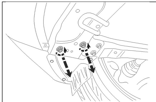
Снять штатный пыльник.
