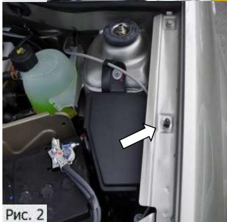
2. Установить болт-шарнир S10 с шайбой 6. Затянуть болт-шарнир S10 высокой торцевой головкой №10 с усилием 9 Нм, (Рис.2).
