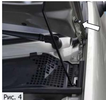
4. Торцевой головкой №10 выкрутить верхний болт крепления капота. Установить вместо него болт-шарнир S12 с шайбой 6. Затянуть болт-шарнир торцевой головкой №12 с усилием 9 Нм, (Рис.4.)
