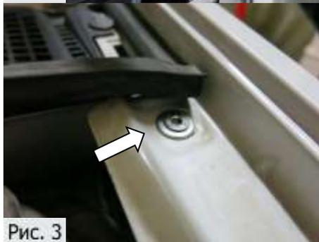
3. Заменить второй болт крепления крыла (ближний к лобовому стеклу) на винт М6х16 с шайбой 6. Затянуть винт М6х16 вставкой-битой HEX4мм с усилием 9 Нм, (Рис.3).
