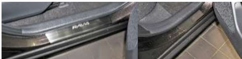
Фото установленных накладок
