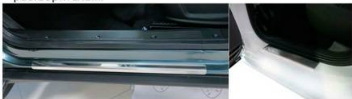
Фото установленных накладок
