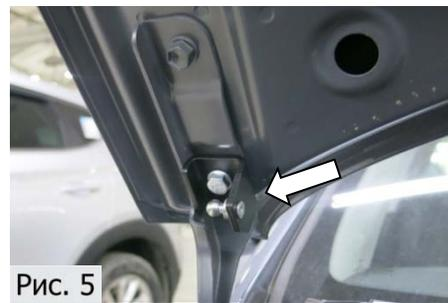
5. Торцевой головкой №12 выкрутить нижний болт крепления капота. Установить кронштейн капота, зафиксировав его болтом М8х20 с шайбой 8. Прижать подгиб кронштейна к ребру петли. Затянуть болт М8х20 накидным ключом №13, (Рис.5).
