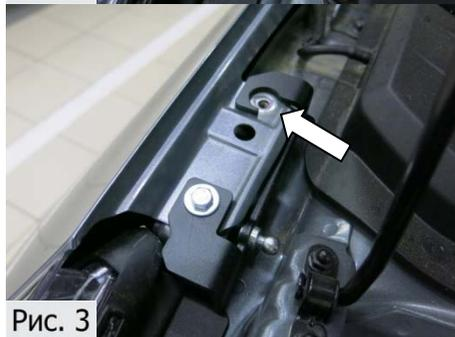
3. Торцевой головкой №10 выкрутить второй болт крепления крыла, (Рис.3).
