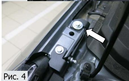
4. Установить втулку. Зафиксировать заднюю часть кронштейна болтом М6х20 с шайбой 6. Затянуть болт торцевой головкой №10 с усилием 9 Нм, (Рис.4).
