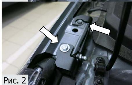
2. Установить кронштейн крыла. Зафиксировать его болтом М6х20 с шайбой 6. Вырез в задней части кронштейна центровать относительно штатного болта крепления крыла. Затянуть болт М6х20 торцевой головкой №10 с усилием 9 Нм, (Рис.2).
