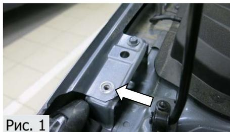
1. Торцевой головкой №10 выкрутить болт крепления крыла (ближний к фаре), (Рис.1).
