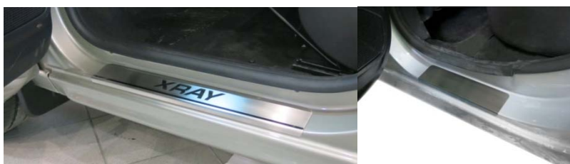
Фото установленных накладок
