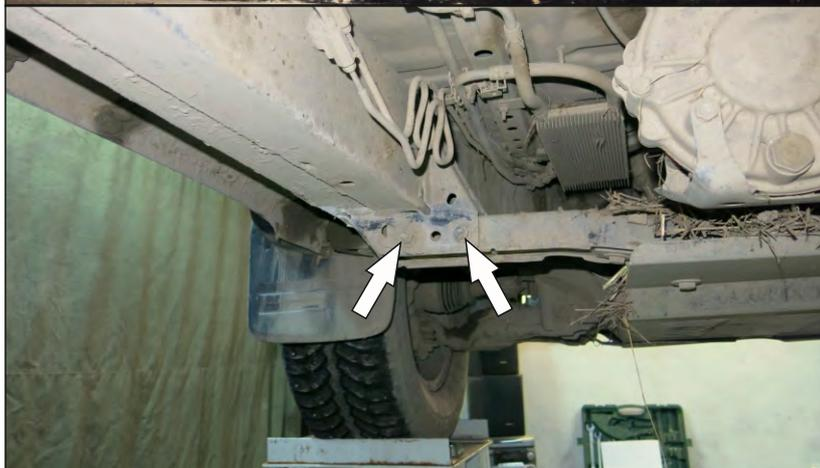
2. Под переднюю поперечную балку подставить упор. Выкрутить два болта крепления балки.
