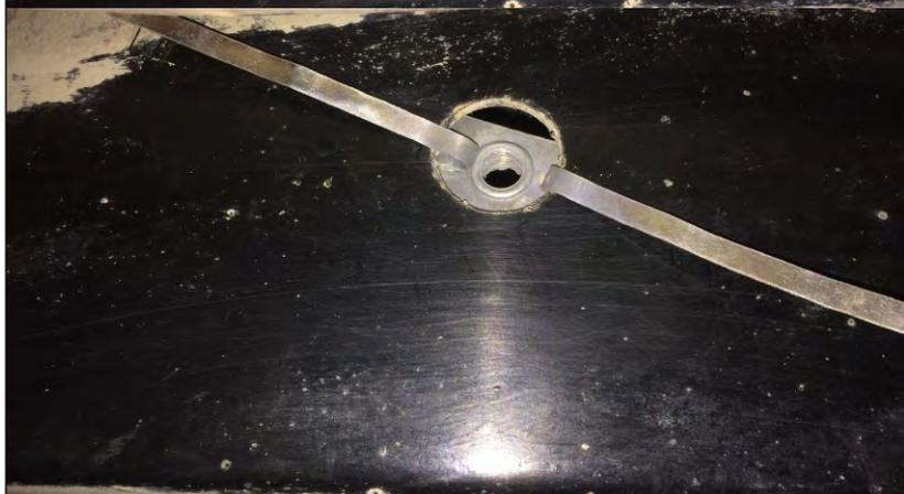
1. В передней части автомобиля установить закладную М10 поз.11 в раму автомобиля, разогнуть усики.
