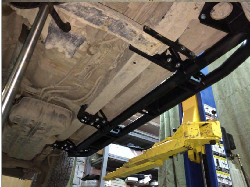
7. Установить порог поз.1 на автомобиль, закрепив его к кронштейнам поз.3, поз.4, поз.6 болтами М12х30 поз.15, гайками М12 поз.17, шайбами М12х27 поз.19. В передней части крепить порог поз.1 к закладной поз.10 болтами М10х25 поз.13, шайбами М10х20 поз.18.
