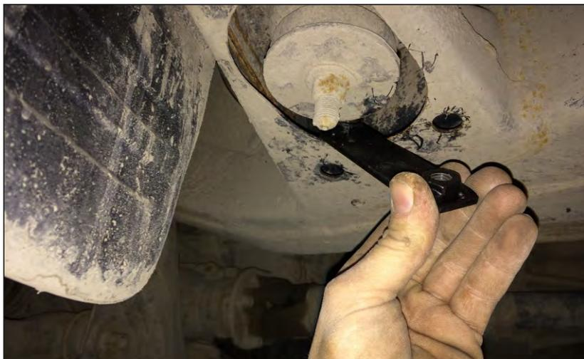
6. В передней части автомобиля установить закладную поз.10 в кронштейн подушки на раме автомобиля.
