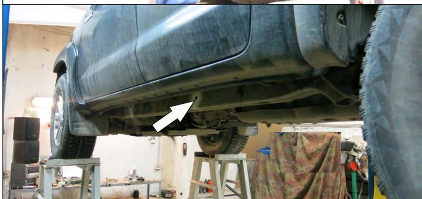
4. Установить средний кронштейн поз.4. Средний кронштейн поз.4 крепить к среднему прижиму поз.5 через втулку 18x12x86 поз.12, установленную в штатное отверстие в раме автомобиля, при помощи болта M12x120 поз.16 и шайбы M12x37 поз.20. В нижней части средний кронштейн поз.4 крепить к среднему прижиму поз.5 болтами M12x30 поз.15, гайками M12 поз.17 и шайбами M12x27 поз.19. Резьбовые соединения не затягивать.
