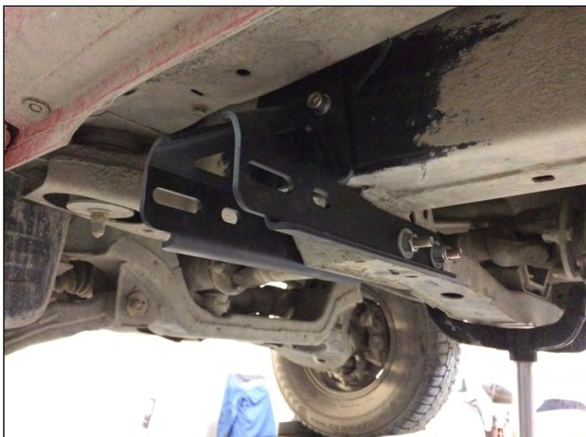
3. Установить передний кронштейн поз.3 на раму автомобиля. Крепить к штатным отверстиям в раме болтами M10x1,25x130 поз.14 с штатными гайками и шайбами. Передний кронштейн поз.3 закрепить к закладной M10 поз.11 болтом M10x25 поз.13 и шайбами M10x20 поз.18. Затянуть все резьбовые соединения.
