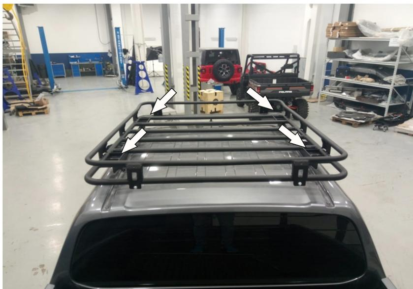
4. Установить багажник на кронштейны поз.3 и поз.4. Закрепить болтами М8х20 поз.7, гайками М8 поз.12 и шайбами поз.13. Отрегулировать багажник, протянуть все резьбовые соединения.
