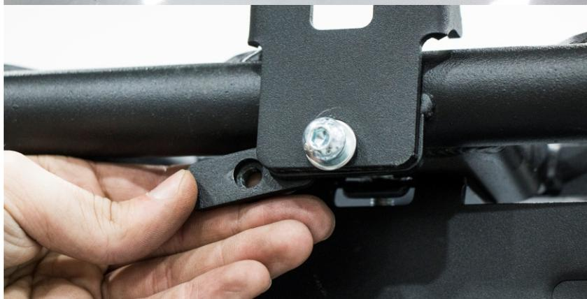
3. Установить верхний ярус поз.2 на нижний ярус поз.1, используя закладную поз.6, винты M8x20 поз.10 и шайбы поз.13. Протянуть все резьбовые соединения.
