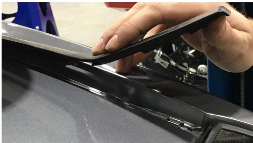
1. Демонтировать пластиковые заглушки штатного крепления багажника на крыше автомобиля.
