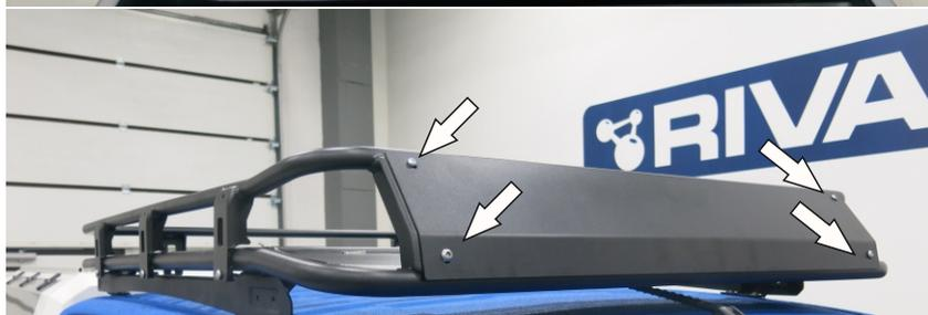
5. Установить дефлектор(поз.5). Закрепить винтами М6х20 поз.8 и гайками М6 поз.11 в верхней части, в нижней части использовать точки крепления верхнего яруса к нижнему и винты М8х20 поз.10
