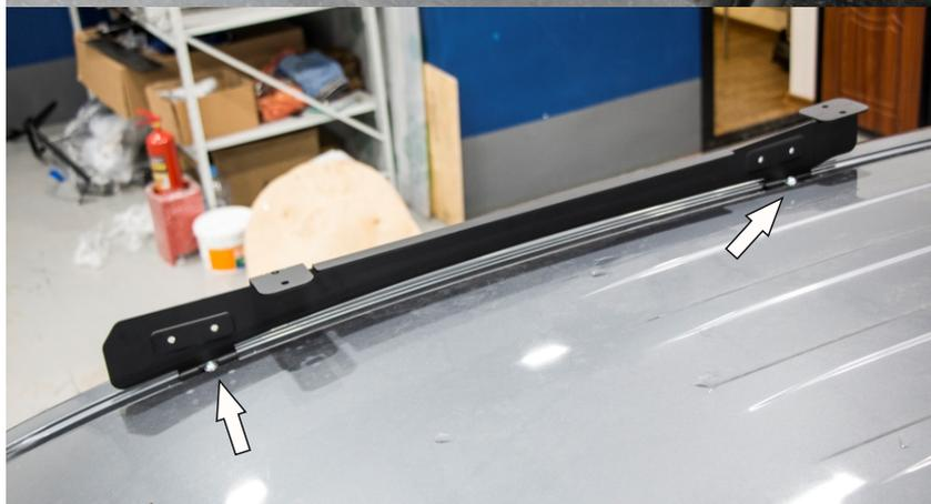
2. Установить кронштейны поз.3 и поз.4 на крышу автомобиля. Закрепить кронштейны винтами M8x12 поз.9 и шайбами поз.13.
