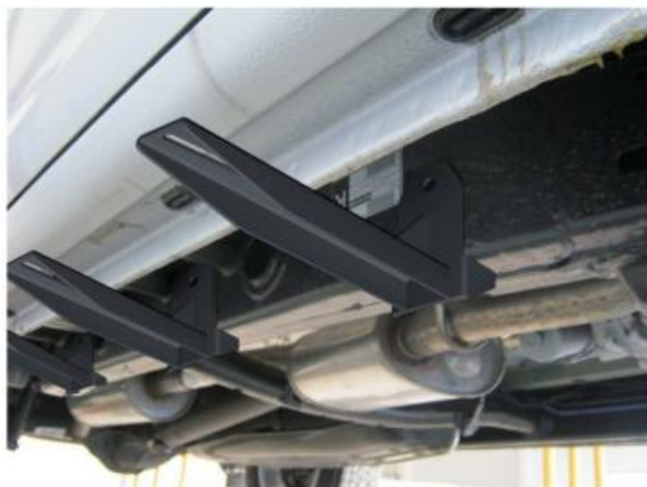
Рис. 8 Автомобиль с установленными кронштейнами
