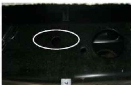
Рис.4 Установка шпильки закладной для крепления заднего кронштейна
