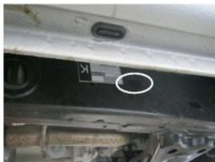
Рис.2 Установка шпильки закладной для переднего кронштейна
