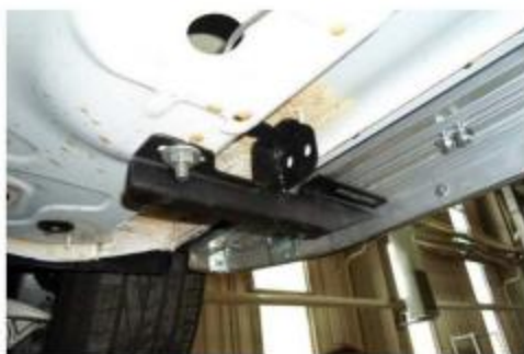
Рис.6 Установка переднего кронштейна
