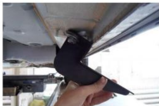
Рис.5 Установка среднего кронштейна
