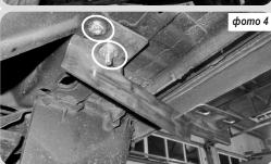
**Внимание!** Максимально допустимая эксплуатационная нагрузка на порог составляет 1029 H, что приравнено к массе человека 105 кг Установленные пороги не изменяют дорожный просвет автомобиля.
