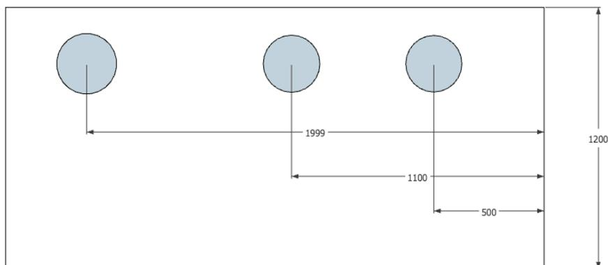
Произвольно выбрать глубину перегородок учитывая монтаж унитаза от стены, для комфортного расположения внутри кабинки (при инсталляции достаточно 1000 мм, классический вариант от 1200мм)
