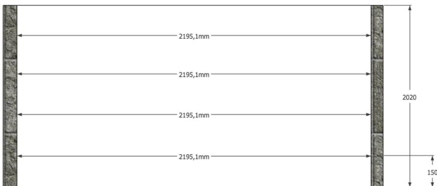
Произвести замер по четырем точкам между стационарными стенками расположения перегородок, не выше 2000 мм и ниже 150 мм, для более точной подгонки фронтальных перегородок (наилучшим вариантом является первичная проверка уровня стен)
