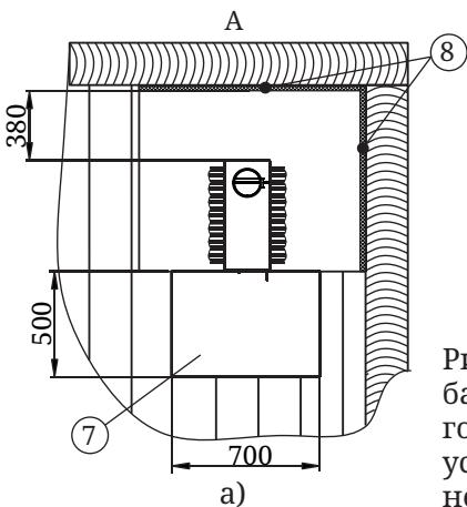
Рисунок 7. Монтаж печи «Огонь-батарея 7 Лайт» в помещении из горючих материалов (дерева) с установкой печи на основание из негорючего материала
