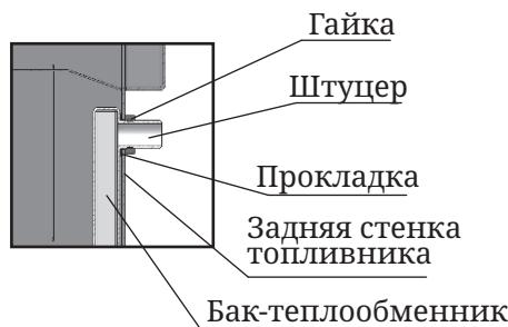
Рисунок 11. Демонтаж теплообменника
