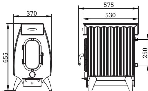
Рисунок 2. Габаритные размеры «Огонь-батарея 7Б Лайт»
