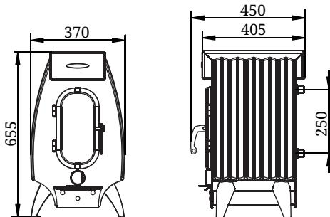
**Рисунок 1. Габаритные размеры
