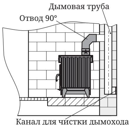
Рисунок 9. Схема присоединения печи к стационарному дымоходу из кирпича в помещении из негорючего материала
