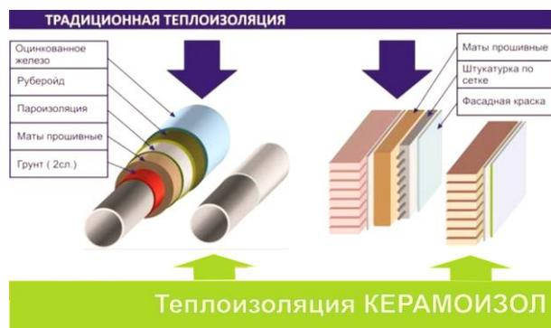
Благодаря высокой степени наполнения полимерного материала стеклянными микросферами, заполненными инертным газом, покрытие обладает низкой теплопроводностью, способностью отражать до 70% падающих лучей света и рассеивать до 95% инфракрасного излучения. Эти свойства способствуют прекрасному сохранению тепла в помещениях, предохранению от солнечной радиации, перегрева поверхности ограждающих конструкций – стен, потолка и крыши.
