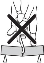
Если цепь зажата или застряла в зоне отдачи, сила реакции будет толкать резак вверх и назад к оператору вращательным движением и может причинить тяжелую или даже смертельную травму. Будьте внимательны и готовы к тому, что объект может сдвигаться. Следите, чтобы обрабатываемый объект не сдвинулся или не произошло что-либо другое, что заставило бы разрез сомкнуться и зажать режущий инструмент.
