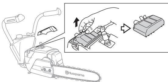
Для более тщательной чистки фильтр следует помыть в воде с мылом.
