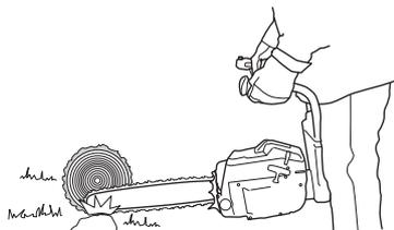
Выполняйте пиление от начала и до конца с верхней части бревна. Попробуйте не коснуться грунта в момент окончания резки. Работайте на полном газу, но будьте готовы, что цепь может коснуться грунта.
