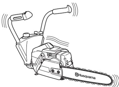
Проверьте, чтобы виброгасящие элементы были надежно закреплены на блоке двигателя и ручках.
