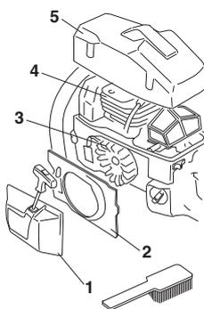
Производите очистку системы охлаждения щеткой раз в неделю или чаще, если этого требуют условия работы. Заряженная или засоренная система охлаждения может привести к перегреву машины и вызвать повреждение поршня и цилиндра.
