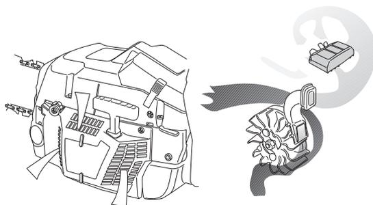
**ВАЖНО!** Для осуществления метода центробежной очистки нужно постоянно выполнять техническое обслуживание и уход за системой. Необходимо чистить воздухозаборник стартера, лопасти вентилятора на маховике, пространство вокруг маховика, входного коллектора и карбюратора.
