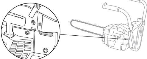
**Газ запуска:** Положение комбинации сытнение/газ запуска получим когда установим ручку в положение сытнения.
