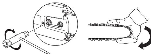
Расположение винта натяжения цепи может быть различным на различных моделях наших моторных пил. См. указания в разделе Что есть что? относительно того, где он расположен на Вашей модели пилы.
