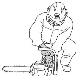
После того, как двигатель сделает первую вспышку, верните сразу рычаг воздушной заслонки в первоначальное положение, открывая воздушную заслонку, и повторите запуск. Когда двигатель запустится, дайте полный газ и отпустите рычаг дроссельной заслонки и блокировка пускового положения дроссельной заслонки отключится.
