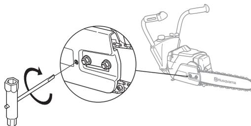
Цепь считается натянутой правильно, если она свободно проворачивается рукой. После этого, удерживая носок пильного полотна в верхнем положении, затяните гайки крепления пильного полотна универсальным ключом.
