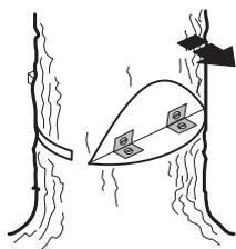
Возможность влияния на направление падения будет полностью утрачена, если полоса разлома слишком узкая или пропилована направляющий и основной пропилы плохо размещены.
