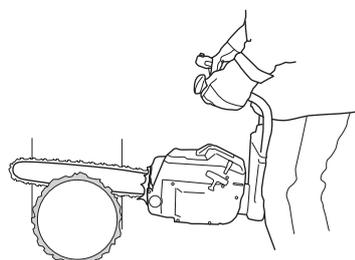
Существуют методы валки деревьев с полотном, меньшим диаметра ствола. Однако эти методы достаточно опасны, т.к. область отдачи полотна входит в контакт с предметом.
