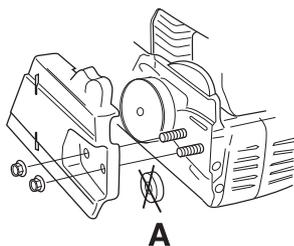
Установите пильное полотно на специально предназначенные болты. Установите полотно в самое заднее положение. Наденьте цепь на ведущую звездочку и вставьте ее хвостовики в паз пильного полотна. Начинайте с верхней стороны пильного полотна.
