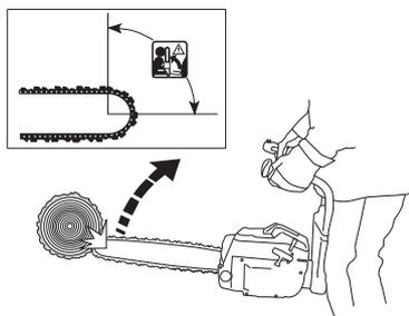
Резка нижней кромкой полотна, т.е. от поверхности объекта к нижнему краю известна как пиление с нажимом. В этом случае моторная пила сама наезжает на дерево и передний край моторной пилы соответствует естественному положению при резке. Пиление с нажимом обеспечивает лучший контроль над моторной пилой и расположением области отдачи.
