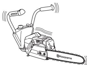
Система виброгашения машины снижает уровень вибрации, передаваемый от двигателя или режущего оборудования на ручки машины. Корпус моторной пилы, включая пильный механизм, висит на ручках, отделен от ручек виброгасящими элементами.
