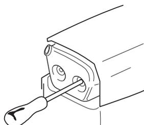
В некоторых глушителях предусмотрен специальный искрогаситель. Если ваша машина оборудована таким глушителем, сетку фильтра следует чистить раз в недел. Наилучшие пользоваться стальной щеткой. Забитая решетка приводит к работе с горячим двигателем, что дает серьезные повреждения двигателя.
