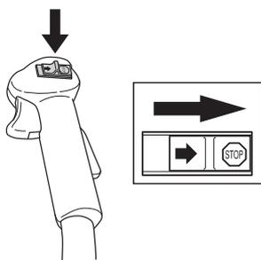
двигатель останавливается, когда контакт остановки будет передвинут в положение остановки.
