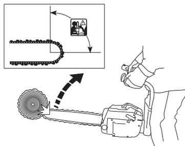
Отдача всегда происходит в плоскости шины пилы. Обычно, отдача моторной пилы и шины происходит слева или справа на пользователя. Моторная пила, однако, в момент отдачи может двигаться и в других направлениях в зависимости от положения моторной пилы в момент касания зоны отдачи полотна и объекта.
