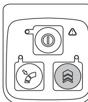
В случае непрерывного использования увеличения мощности потока воздуха (наддува) на протяжении более 5 секунд мощность потока воздуха вернется к первоначальному уровню. Индикатор включения (светодиодная лампа) функции наддува будет мигать до тех пор, пока функция наддува не будет снова доступна.
