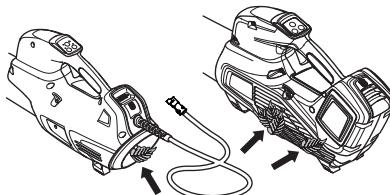
Убедитесь, что воздуховод со всех сторон устройства не заблокирован, например, листьями или мусором. Забитый воздуховод приведет к снижению производительности и повышению рабочей температуры двигателя, в результате чего возможна поломка. Остановите двигатель и извлеките посторонние предметы.
