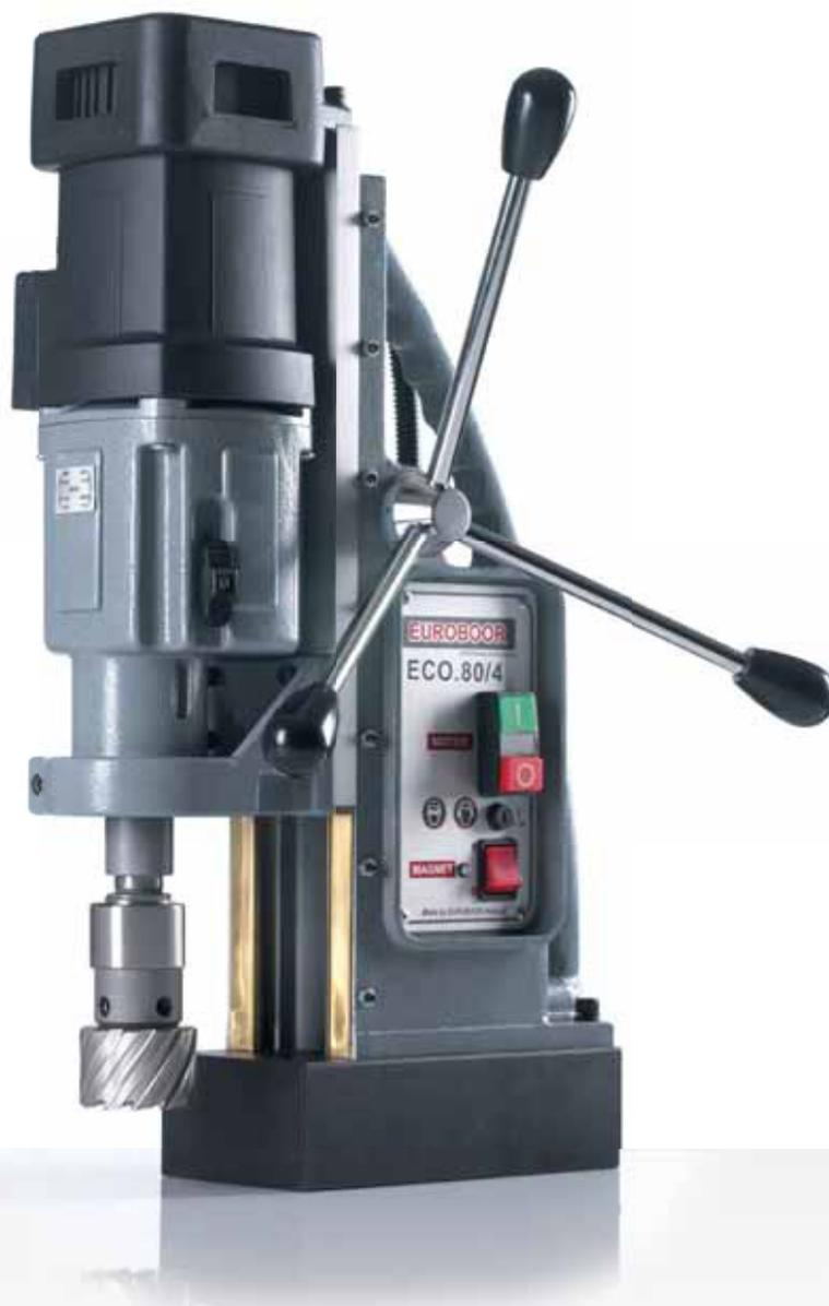
ECO.80/4 это мощный станок с соединением Конус Морзе 3. Благодаря 4 скоростям и механической защите мотора от перерузок, этот сверлильный станок идеально подходит для глубокого сверления длинными спиральными сверлами с захватом KM.3 и диаметром до 31,75 мм.
