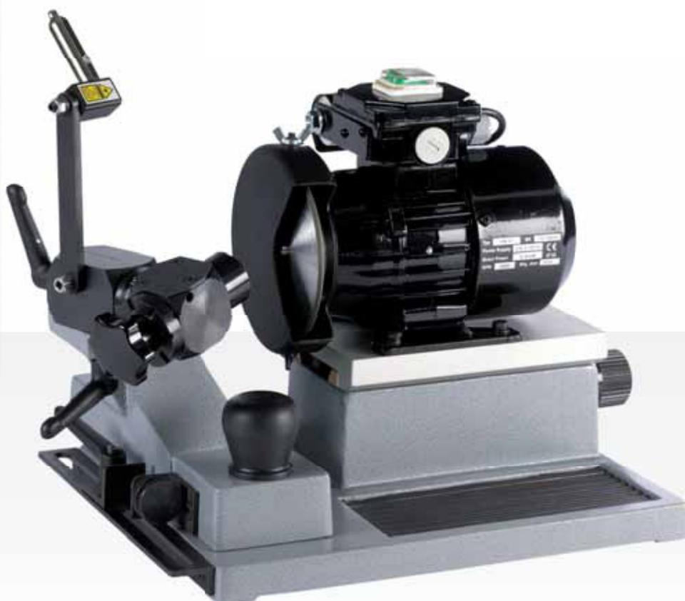
Шлифовально-заточная машина ERM.100/2 предназначена для заточки кольцевых фрез из HSS быстрорежущей стали и HSS-Cobalt фрез. Машина снабжена лазерным индикатором, который позволяет очень аккуратно настроить угол заточки зубьев фрезы.
