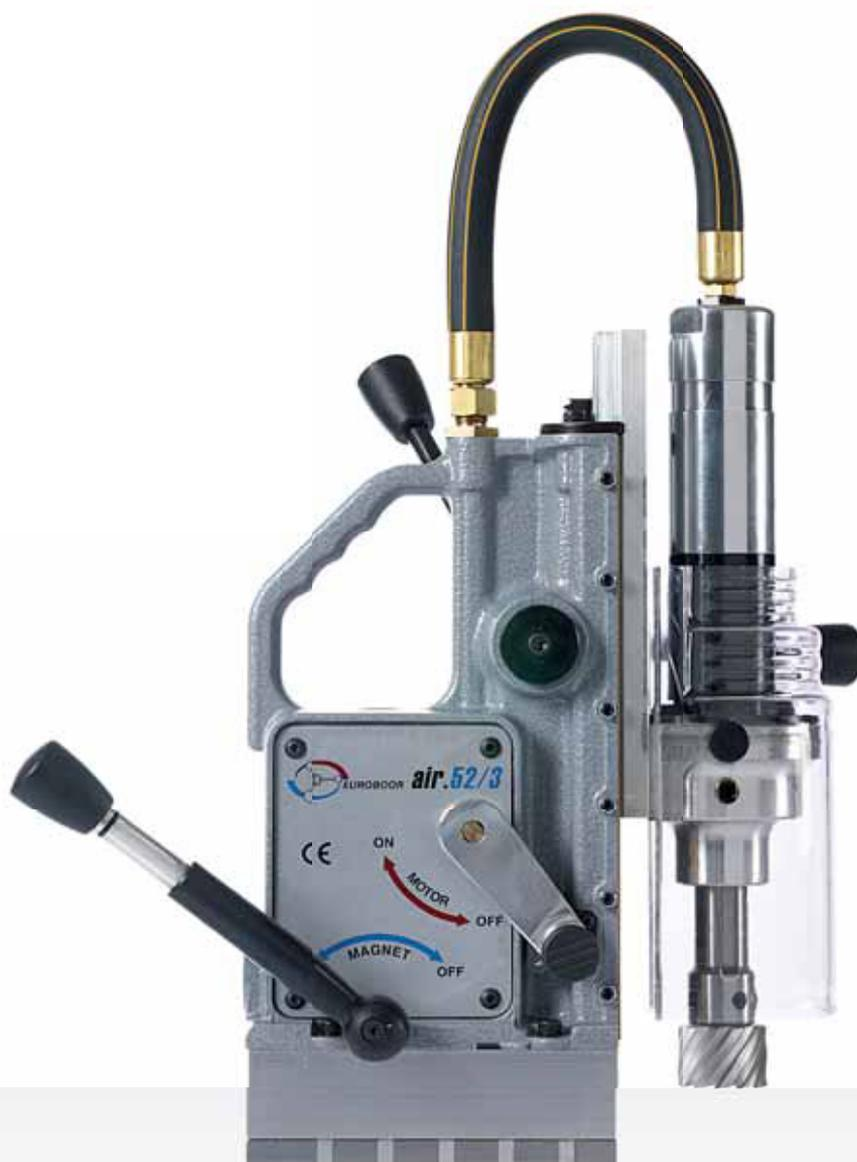
AIR.52/3 предназначен для обработки металлов в взрывоопасных зонах где электрическая искра недопустима, Используется в нефтяной и газовой промышленности, на электростанциях, в судостроении и морской промышленности. Этими машинками часто пользуются спасатели при подъеме затонувших судов.
