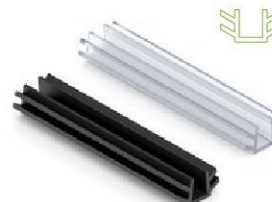
AA0084.VM100 Уплотнитель П-образный, с шипами Цвета: прозрачный, черный Высота - 4 мм, В бухте - 100 м
