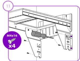
ПРИКРУТИТЕ ОБА ДВЕРНЫХ РЫЧАГА К ФАСАДУ С ПОМОЩЬЮ ПРОРЕЗНЫХ ОТВЕРСТИЙ
