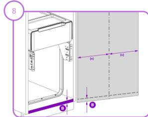
ИЗМЕРЬТЕ И ОТМЕЙТЕ ЦЕНТРАЛЬНУЮ ЛИНИЮ И ОСНОВАНИЕ ШКАФА НА ДВЕРЦЕ
