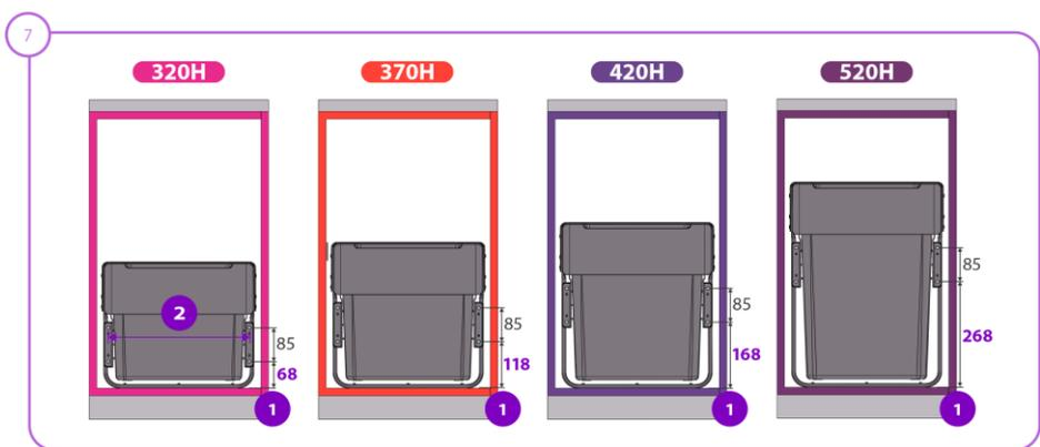
2 В ЗАВИСИМОСТИ ОТ ШИРИНЫ КОРПУСА, ВЫБЕРИТЕ РАЗМЕР МЕЖДУ ОТВЕРСТИЯМИ В КРЕПЛЕНИИ
