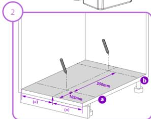
ИЗМЕРЬТЕ И ОТМЕЙТЕ ЦЕНТРАЛЬНУЮ ЛИНИЮ ПОЛИКА. ОТМЕЙТЕ ЛИНИИ **a** И **b**
