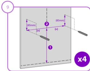
ИСПОЛЬЗУЯ ШАГ 7, НАЙДИТЕ ВЫСОТУ 1 И ШИРИНУ ОТВЕРСТИЯ 2 И ОТМЕЙТЕ 4 ОТВЕРСТИЯ, КАК ПОКАЗАНО ВЫШЕ
