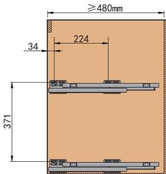
Используйте для присадки монтажные размеры, указанные на чертеже. Закрепите направляющие к базе с помощью саморезов ST4x16
