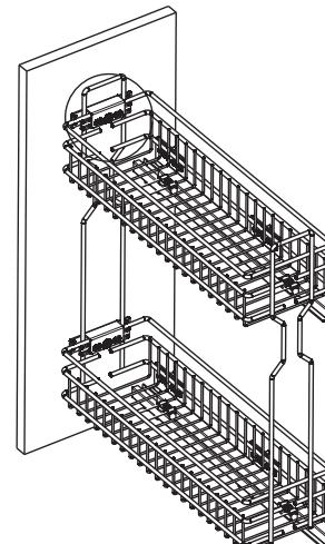
Отрегулируйте фасад с помощью этих двух винтов
