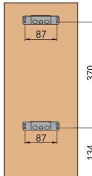
Используйте для присадки монтажные размеры, указанные на чертеже. Зафиксируйте крепление к фасаду с помощью саморезов ST4 \* 16
