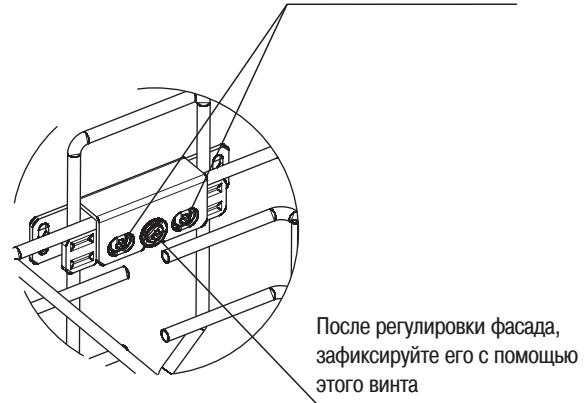
После регулировки фасада, зафиксируйте его с помощью этого винта
