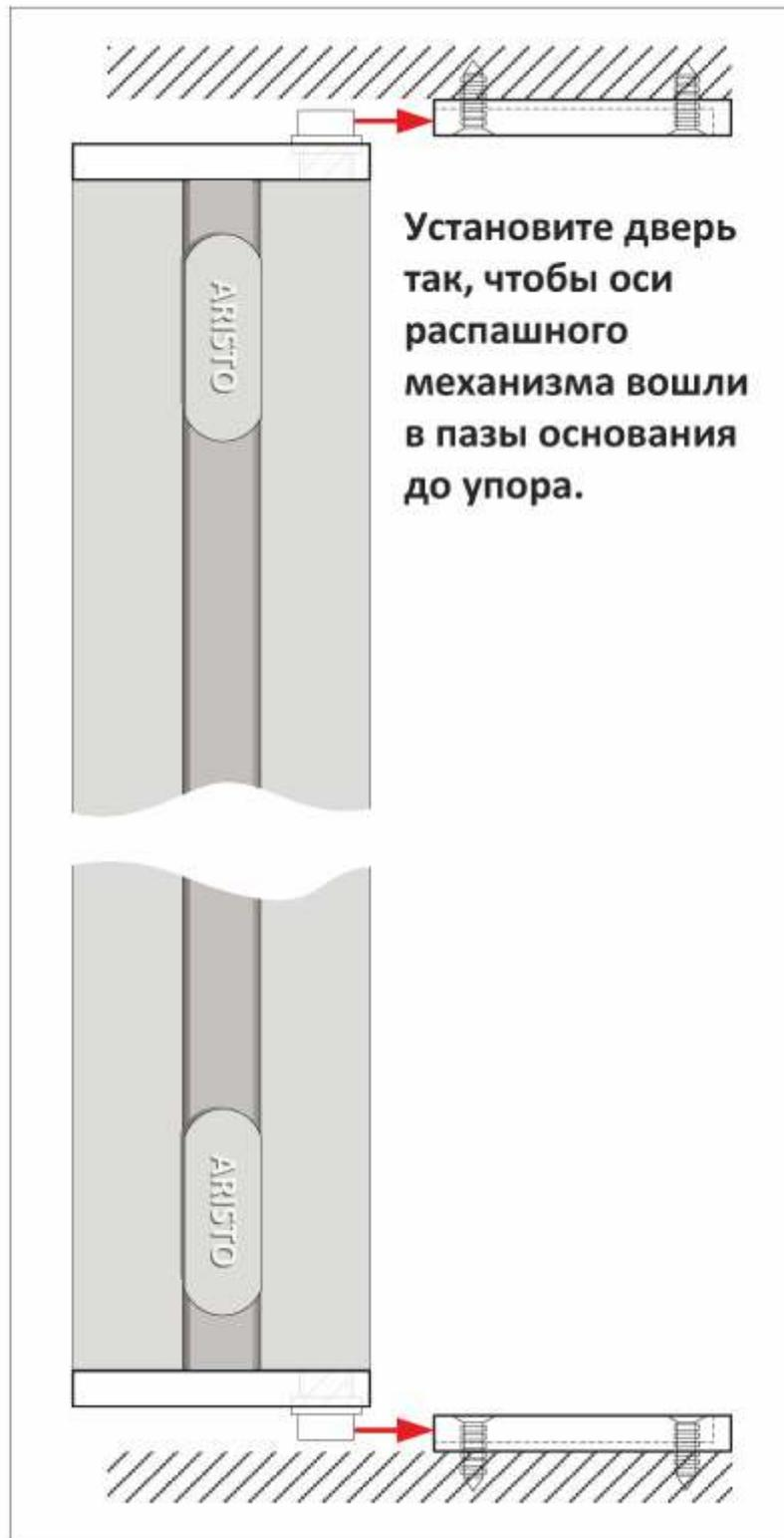
10. Зафиксируйте дверь в основаниях шкафного распашного механизма при помощи стопорных планок:
