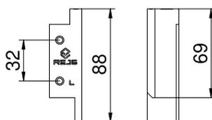
крепление задней стенки шуфляды ящика
