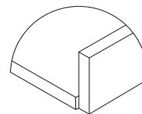
монтаж задней стенки за дном ящика
