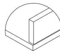
монтаж задней стенки на нижней части ящика
