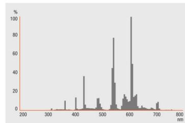
DULUX T/E PLUS 13 W/830, DULUX T/E PLUS 18 W/830, DULUX T/E PLUS 26 W/830, DULUX T/E PLUS 32 W/830, DULUX T/E PLUS 42 W/830
