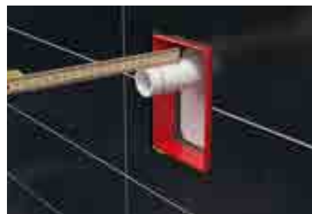
6. Отметить на резьбовой патрубке расстояние 3 см, измеряется от поверхности стены (плитки)
