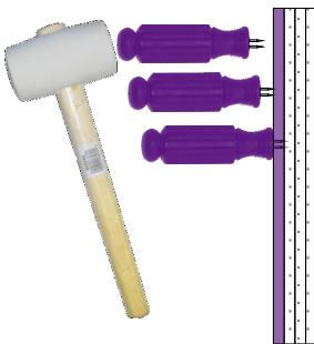
► Ces outils vont vous permettre de pré-percer la plaque de plâtre de 6mm des panneaux **PixBOARD™** afin de venir ensuite y positionner les luminaires **PIXLUM®** sans effort et sans risque de casse.
