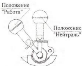
Рисунок 10 - Механизм включения косилки к мотоблоку «Угра».
