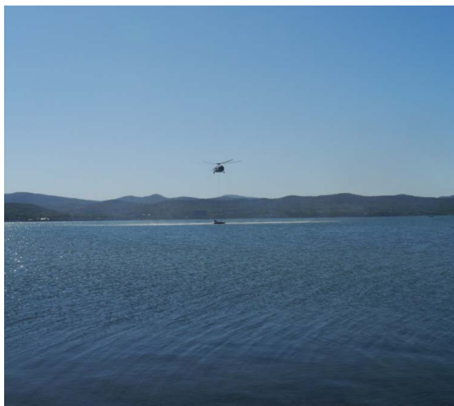
Рисунок 2.3 – Забор воды, путём опускания ВВСУ на поверхность воды
