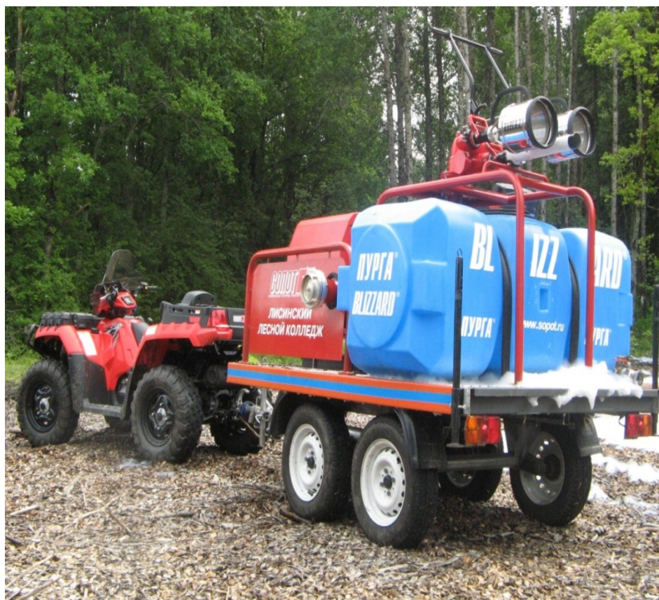
Рисунок 3.21 – Общий вид передвижного пожарного модуля
