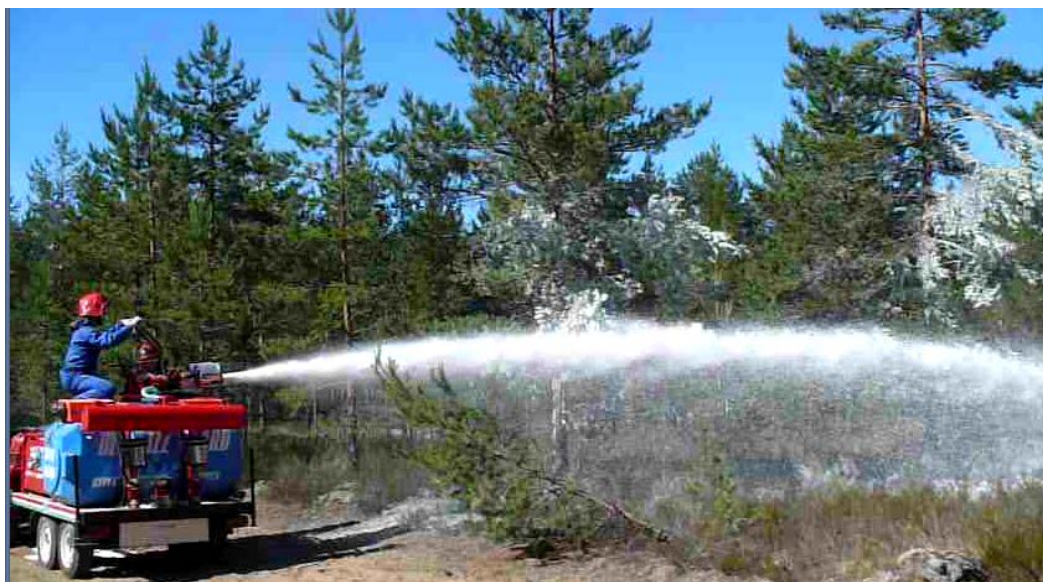
Рисунок 3.22 – Подача быстротвердеющей пены при низком угле наклона лафетного ствола Пурга-2, установленного на передвижном пожарном модуле
