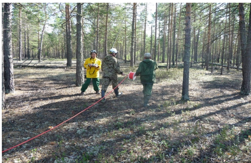
а) – Прокладка линии подрыва детонирующим шнуром ДШН -80
