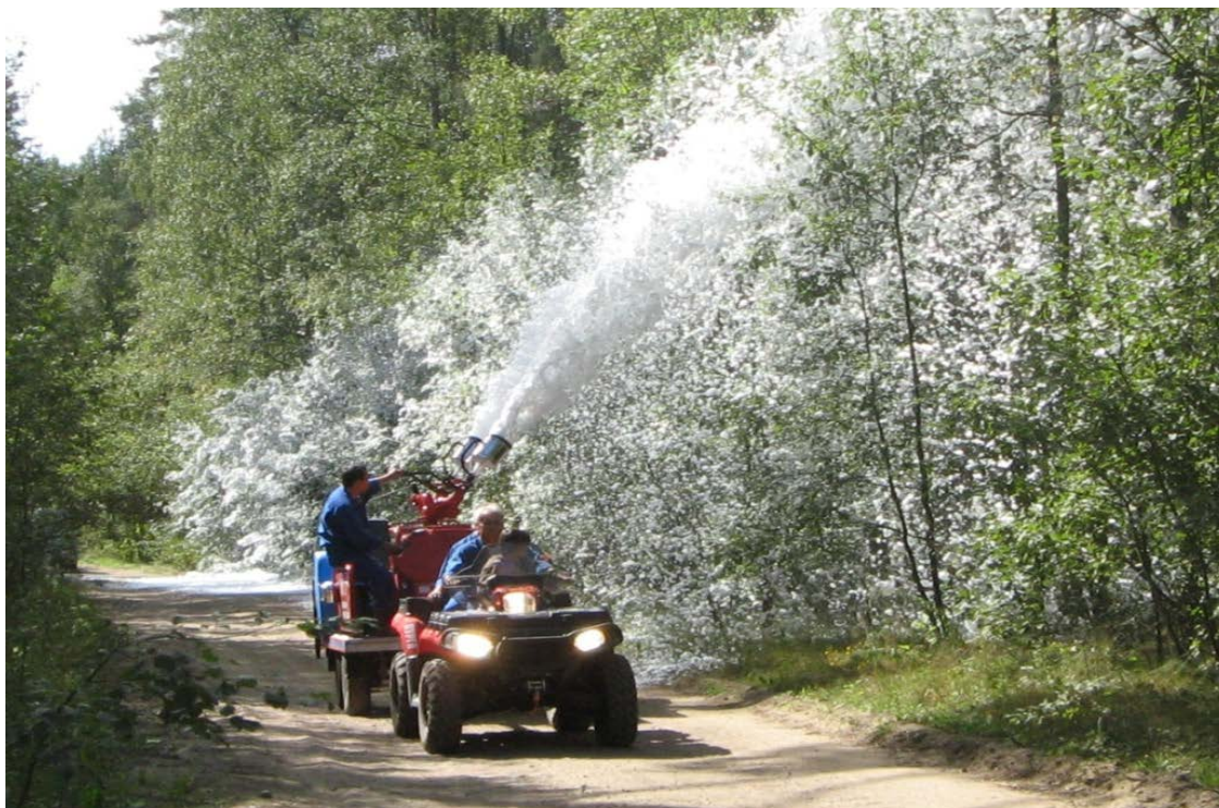
Рисунок 3.24 – Подача пены с помощью установки комбинированного тушения УКТП «Пурга 2»
