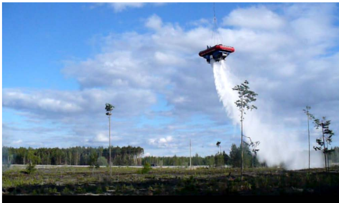
Рисунок 3.15 – Первый слив быстротвердеющей огнестойкой пены с ВВСУ «ПУРГА» 30x2 на КИП, оборудованный на вырубке, Сургутское лесничество, 26 мая 2015 г.
