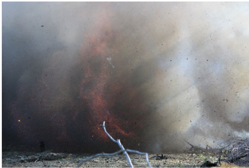
Рис. 2.7. Процесс выброса и дробления грунта в результате взрыва
