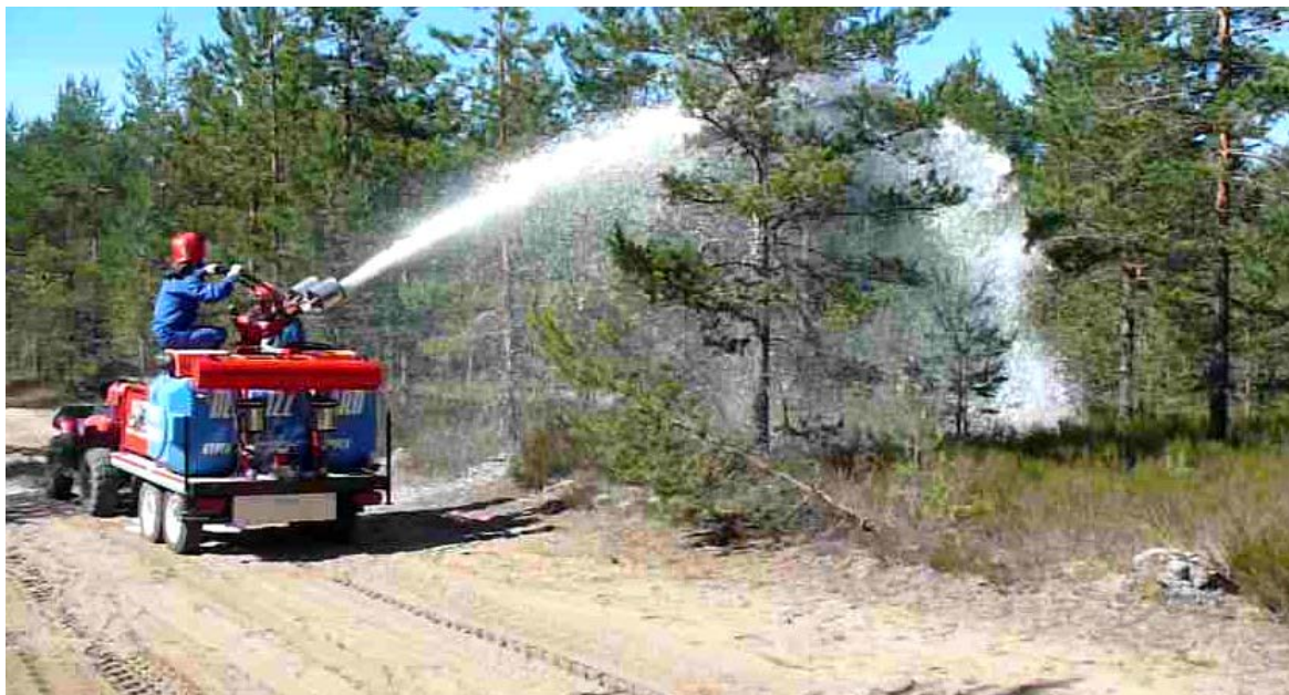
Рисунок 3.23 – Подача быстротвердеющей пены при высоком угле наклона лафетного ствола Пурга-2, установленного на передвижном пожарном модуле
