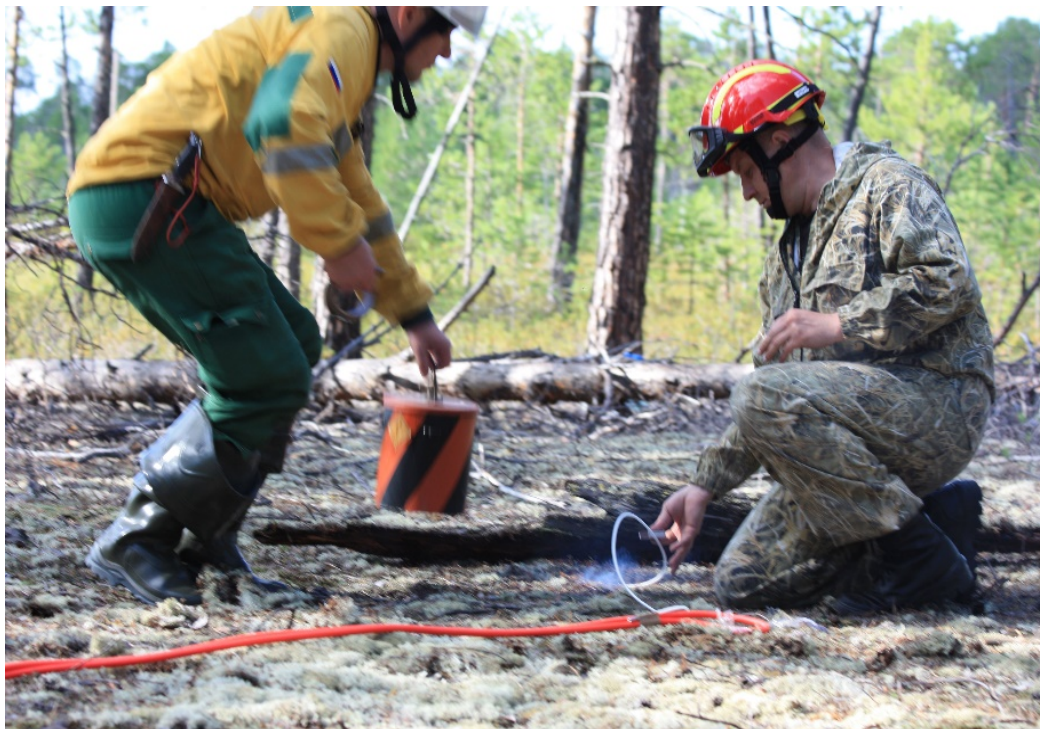
Рисунок 2.11 – Взрывание линии ДШН-80 путём поджога огнепроводного шнура
