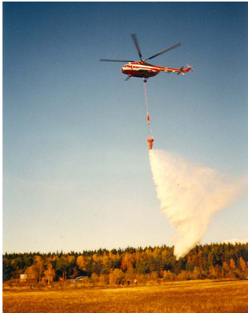
Рисунок 3.3 – Слив раствора пенообразователя из вертолетного водосливного устройства ВСУ-5А в комплекте с системой СДП-1
