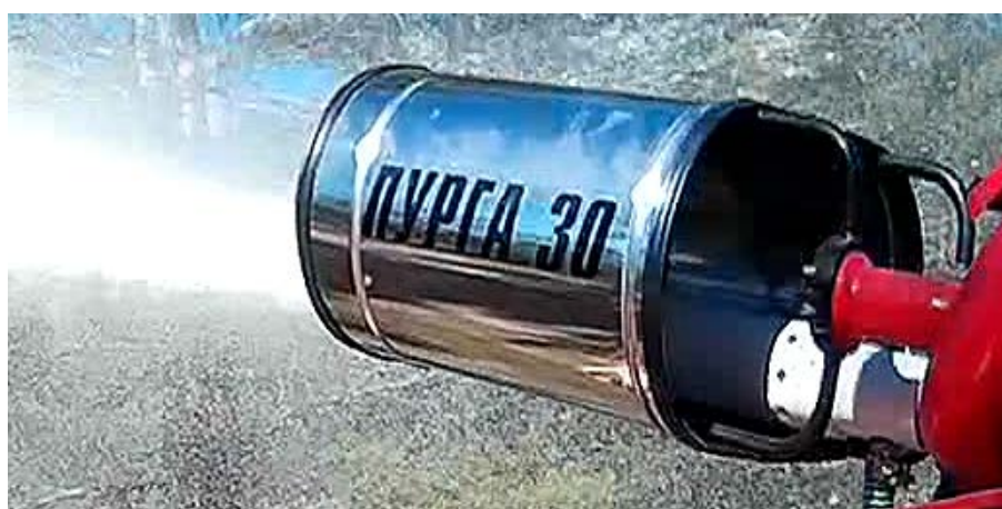
Рисунок 3.12 – Генерация огнестойкой быстротвердеющей пены с помощью УКТП «Пурга»
