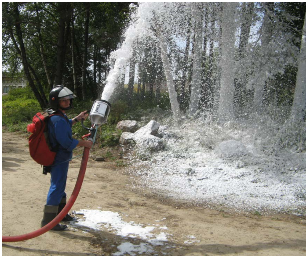
Рисунок 3.25 – Подача пены с помощью ранцевого Устройства пожаротушения РУП с УКТП «Пурга 2»
