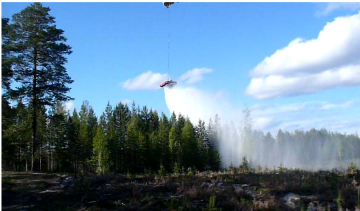
Рисунок 3.16. Второй слив быстротвердеющей пены на лесной КИП с помощью ВВСУ с УКТП «Пурга 30x2»,
