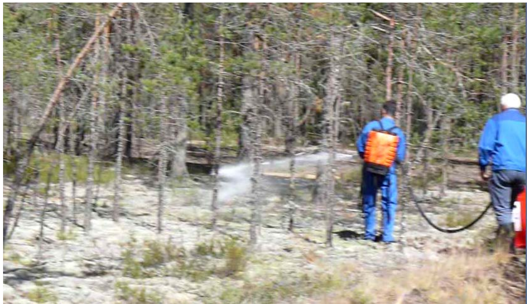
Рисунок 3.20 – Подача огнестойкой быстротвердеющей пены из огнетушителя ВП-50-СДКП
