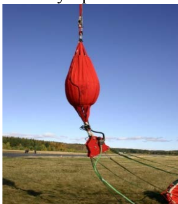
Рисунок 5 – Система дозированной подачи огнетушащих составов СДП-1 в комплекте с водосливным устройством ВСУ-5А
